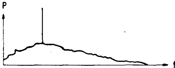
Fundamental + ruido de banda ancha
