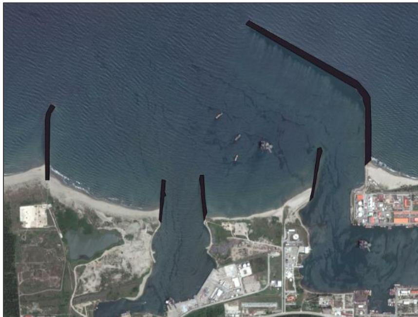
**Figura 4** Estructuras de protección artificial en puerto Paraíso, Tabasco.
