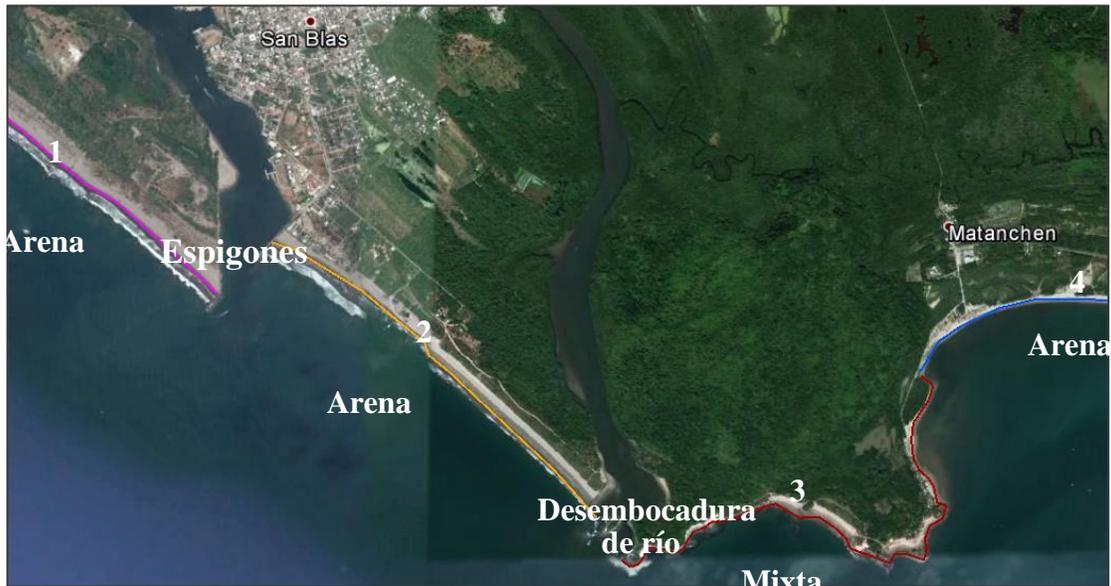
**Figura 6** Compartimentos delimitados por el tipo de costa, la presencia de estructuras de protección artificial y la desembocadura de un río.
