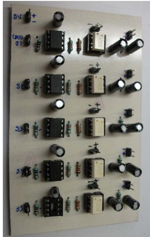
Figura 63. Aislamiento de las señales por medio de los opto acopladores 6N137 y excitadores de compuerta TLP250
