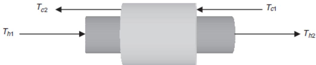
Ilustración 2—6 Sección de un intercambiador double-tube
