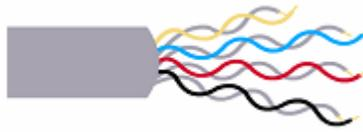
Figura 18 Cable de Par Trenzado
