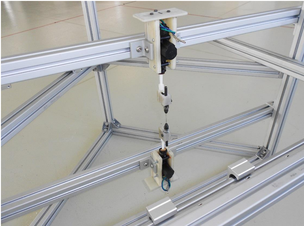
Figura 23. Imagen final del sistema de Inserción de hilo montado en el prototipo de máquina bordadora.
