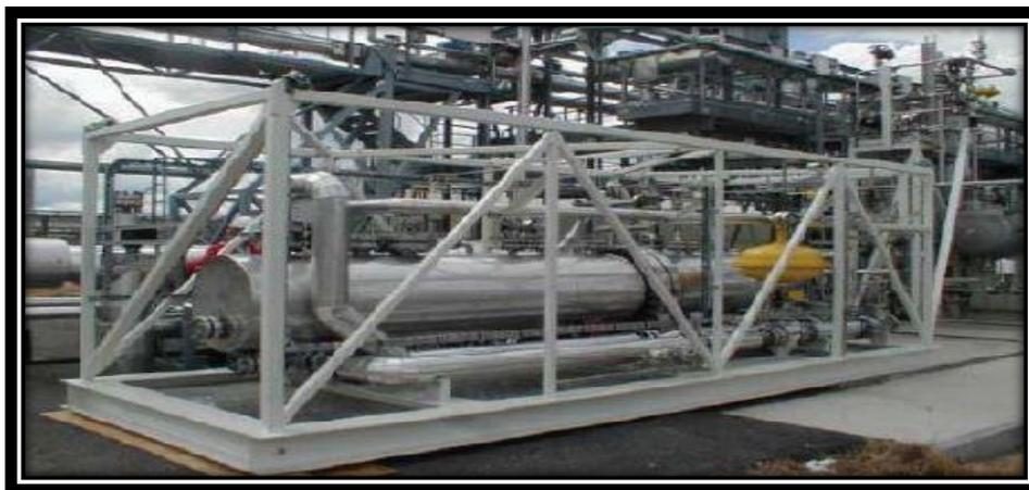
**Figura 4-6** Esquema del separador de prueba con internos electrostáticos (Modificado de Chiesa et al., 2010).
