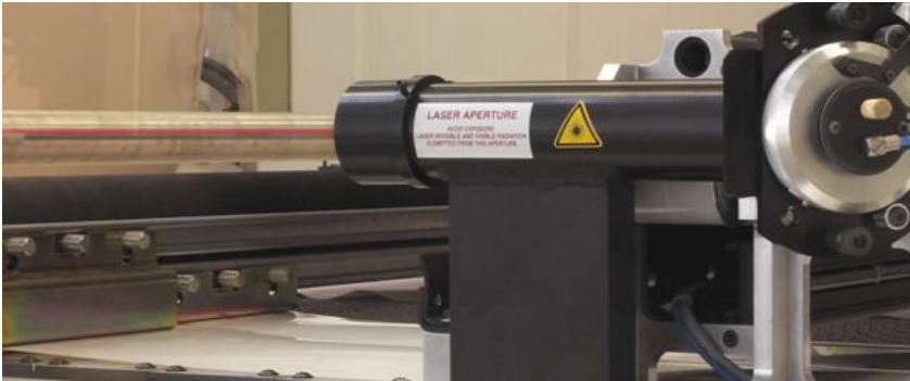
Figura 6.1. Ejemplo de etiqueta de seguridad en el paso de rayo Laser por un telescopio
