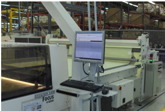
Fig. 9.9 Sistema de alimentación de una capa con escáner.
