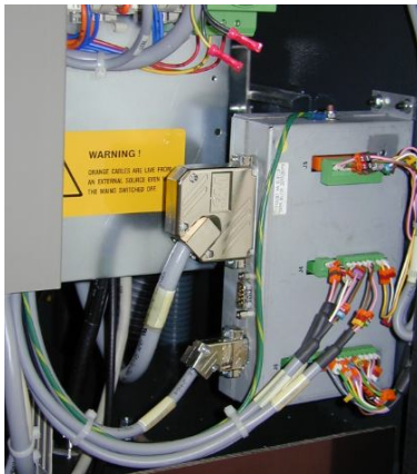
Fig. 9.13 Control de potencia e interface de comunicación entre laser y cortadora
