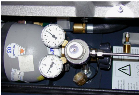
Fig. 9.25 Tanque de gas Rofin, pueden verse los manómetros de presión en el tanque y en la cavidad
