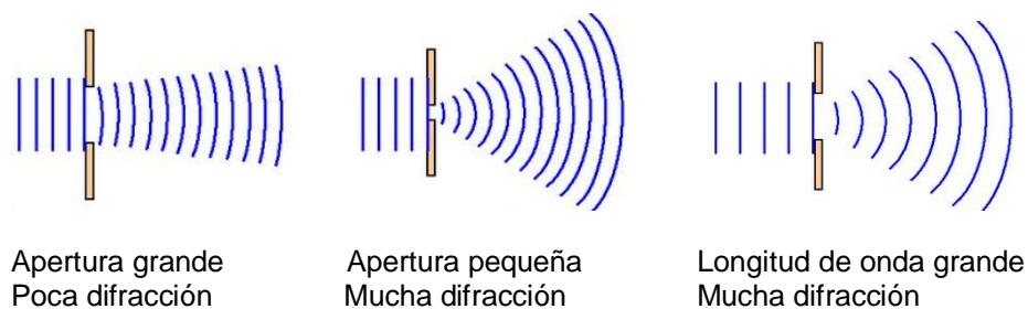
Figura 4.2. Difracción obtenida al incidir un laser de diferente \lambda en diferentes aberturas
