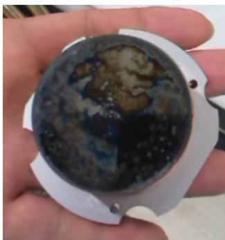
Figura 7.8. Espejo dañado por condensación
