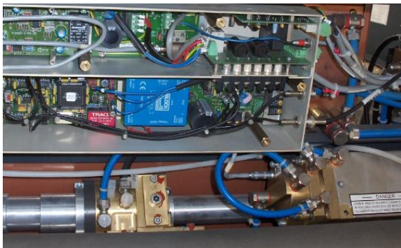
Fig. 9.22 Caja Z en un resonador Laser y spacial filter en medio del telescopio interno
