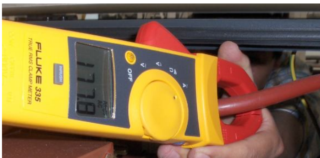
Fig. 9.18 Ajuste de corriente de filamento a 178 A
