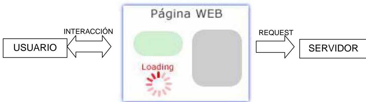
Figura 3.24 Diagrama a bloques de la interfaz de AJAX
