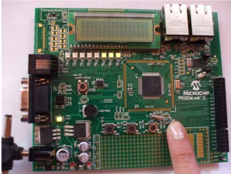
Figura 3.10 Primer prueba con la tarjeta-Encendido de led's
