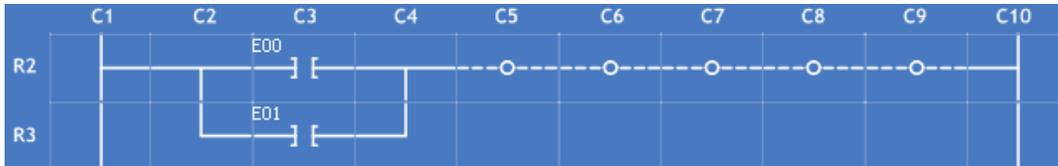
Figura A.66 – Inserción de la Entrada E01 en la Columna C3 del Renglón R3 en la estructura “Conectores el Inicio”.
