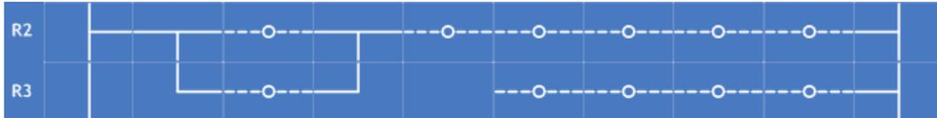
Figura A.62 – Estructura insertada en los Renglones R2 y R3 por la ventana de configuración “Conectores al inicio”.
