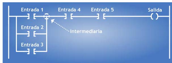
Figura A.94 – Compuerta Lógica OR de tres entradas cuya Salida es la Entrada de una Compuerta Lógica AND,
