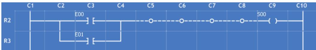
Figura A.67 – Inserción de la Salida S00 en la Columna C9 del Renglón R2 en la estructura “Conectores el Inicio”.
