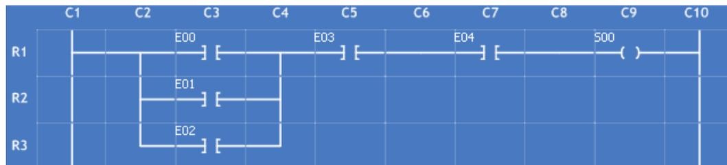
Figura A.96 – Compuerta Lógica OR de tres entradas cuya Salida es la Entrada de una Compuerta Lógica AND.
