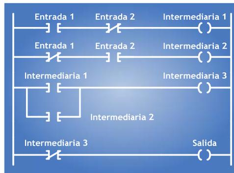
Figura A.92 – Compuerta Lógica XOR de dos Entradas en el Diagrama de Escalera.
