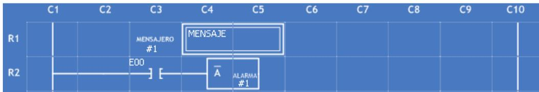
Figura A.218 – Alarma Generadora de Mensajes junto con el Mensajero Asociado en el renglón R1.
