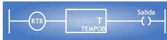
Figura A.189 - Temporizador Generador de Pulsos con Reloj en Tiempo Real en el Diagrama de Escalera.
