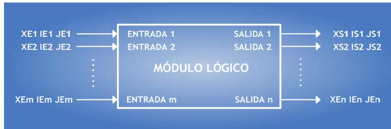
Figura 1.5 Representación de bloque de un módulo lógico de m entradas y n salidas
