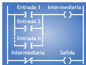
Figura A.79 – Compuerta Lógica NOR en el Diagrama de Escalera.
