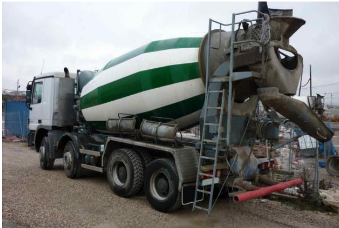
8 Figura 6. Camión revolvedor de concreto “olla”
