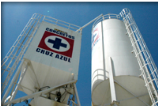
10 Figura 8. Silos para contener y verter el cemento
