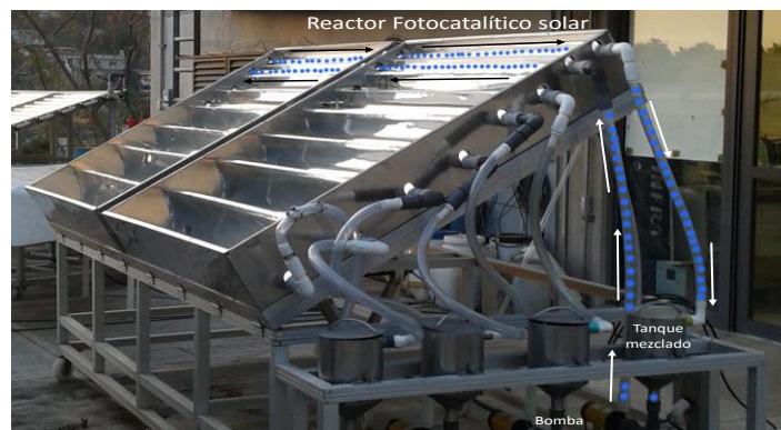
Fig. 3.2 Diagrama del esquema experimental a nivel de planta piloto
