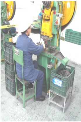
Figura 3.9 Operación de punzonado de registro
