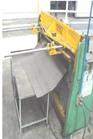
Figura 3.6 Operación de corte de tira
