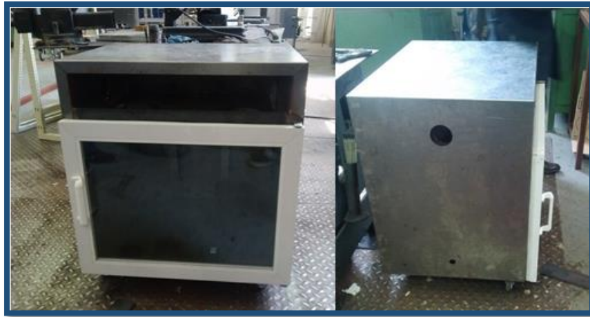
Figura 41. Ensamble con láminas exteriores y puerta.
