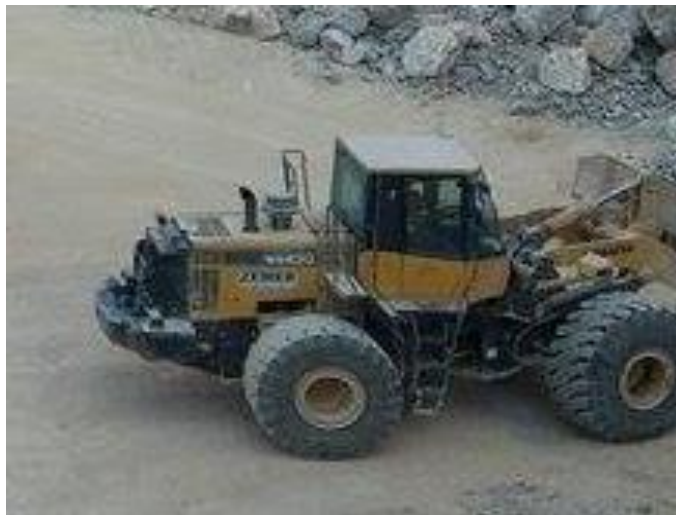
Figura 1.8 Cargador Frontal. Cucharón de 3.3 m 3
