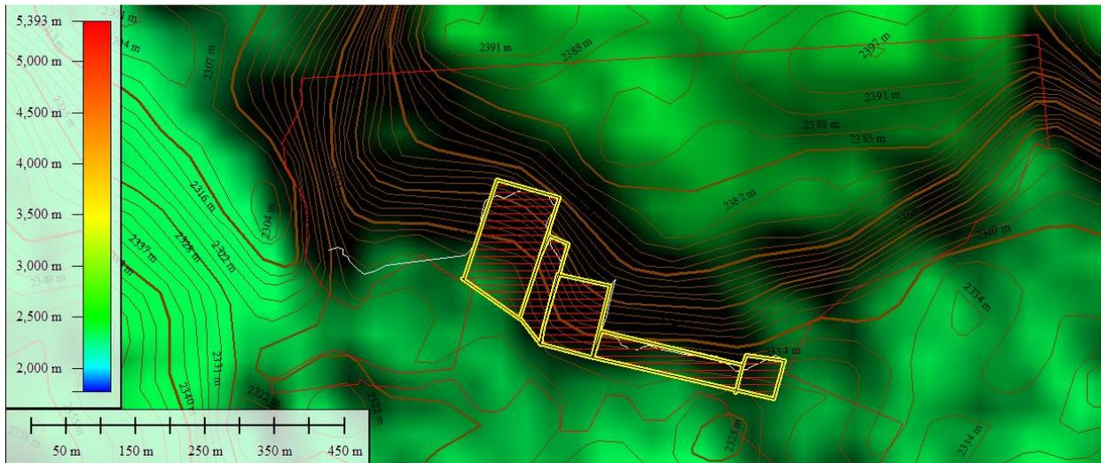
Figura 3.31 áreas del frente de ataque para obtener sus volúmenes
