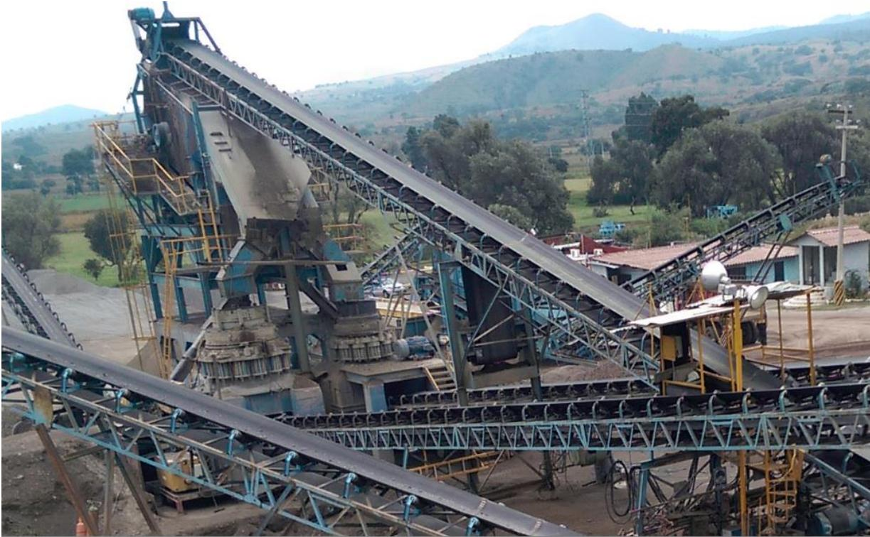
Figura 4.11 Quebradoras de cono y bandas transportadoras
