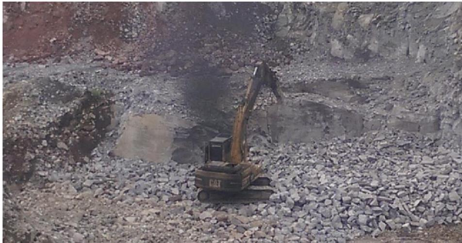
Figura 4.2 Uso de martillo hidráulico para desprender la roca
