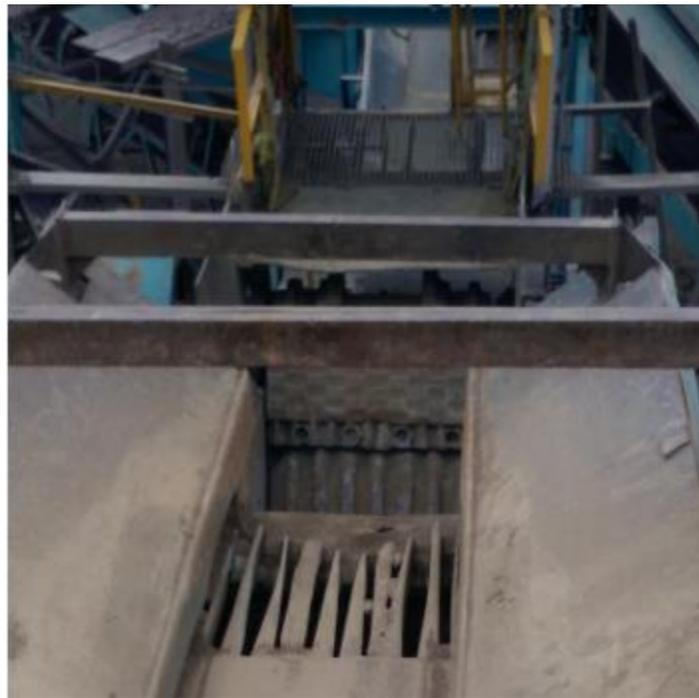
Figura 4.7 Tolva de gruesos y trituración primaria con una quebradora de quijada
