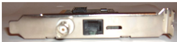
Figura 55. Conector BNC y RJ45 de una tarjeta de red. 29
