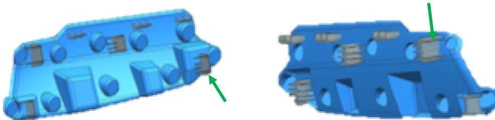
Figura 68: Agregar elementos de sujeción.
