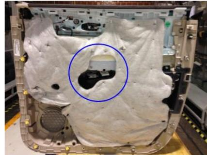
Sound Absorber de fibras de polipropileno
