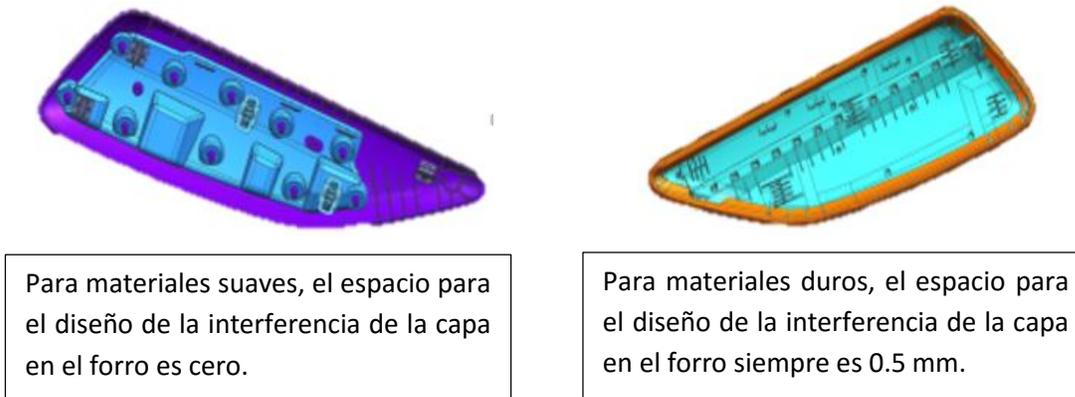
Figura 49: Especificaciones técnicas de diseño - Knee Pad
