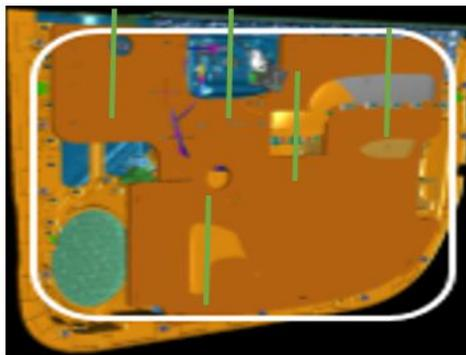
Figura 14: Secciones para ejecución de diseño - sound absorber
