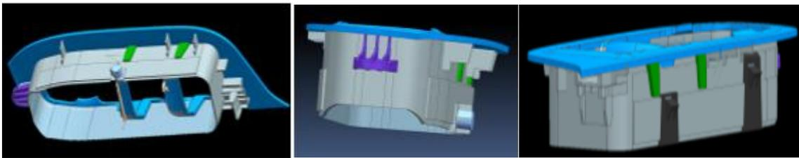
Figura 95: Agregar dispositivos de sujeción.
