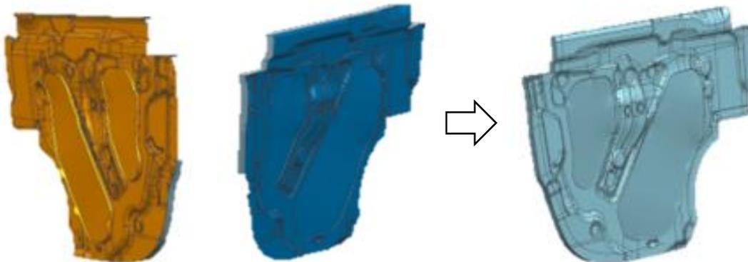
Figura 30: Paso 9 – Cosido – Componente Final.
