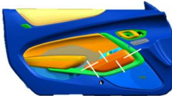
Figura 48: Secciones para ejecución de diseño - Knee Pad
