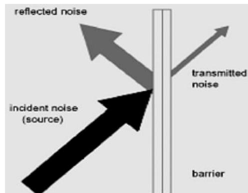
Figura 2: Ondas incidentes/transmitidas/reflejadas.
