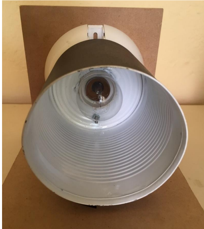
Ilustración 21: Montaje de socket y tubo de aluminio en soporte de madera.
