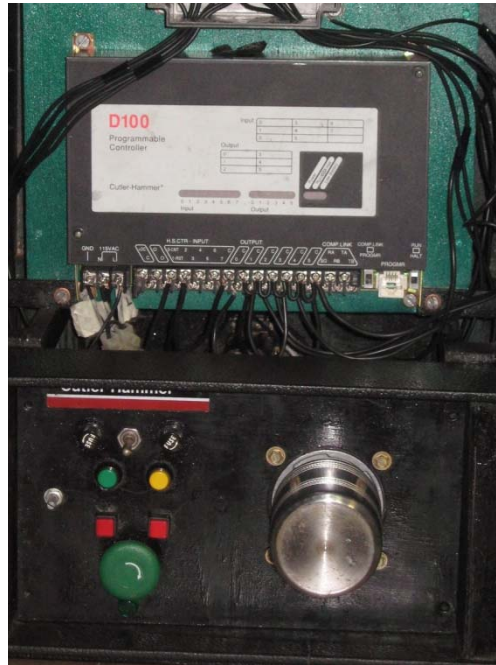
Figura 150 Modo de operación de control de entrada digital con potencial de arranque nulo y operación automática a través del PLC.
