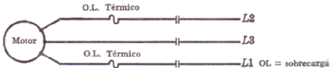
Figura 50 Diagrama esquemático de alambrado para un arrancador manual trifásico.
