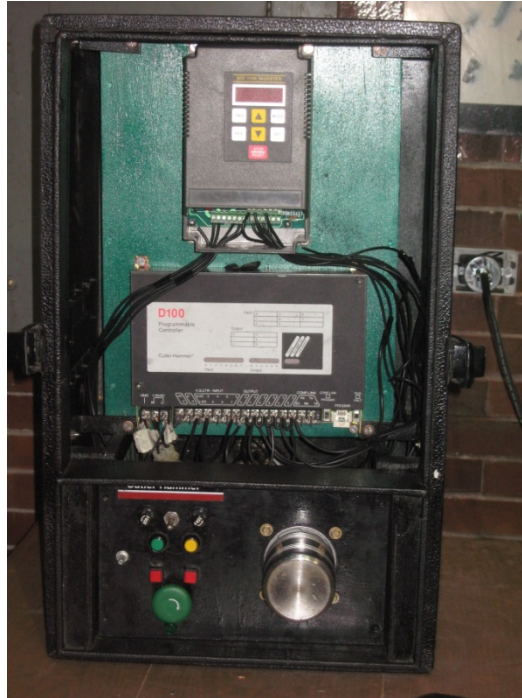
Figura 148 Modo de operación de control de entrada digital con potencial de arranque distinto de cero y operación manual.
