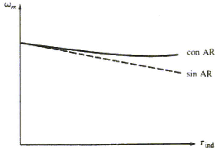
Figura 6 Característica momento de torsión – velocidad del motor que presenta reacción de armadura.
