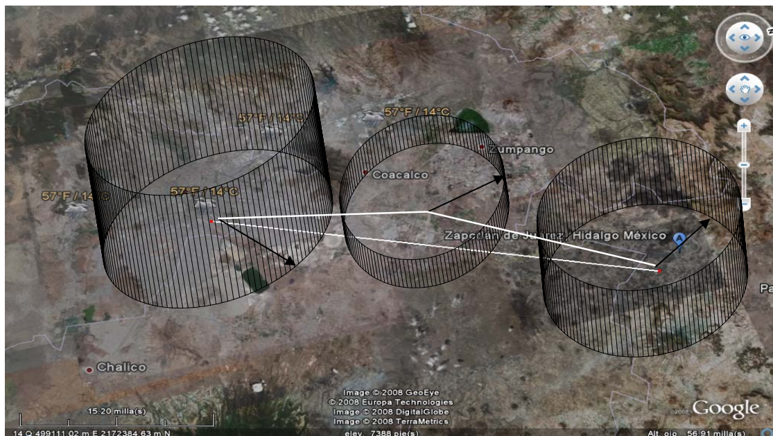
Figura 4.16. Espacios aéreos terminales de aproximación de 10 MN para el AICM, base aérea militar de Sta. Lucía y del nuevo aeropuerto de carga Tizayuca, Hgo.
