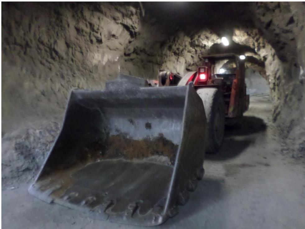
*Fig. 7. Cargador frontal modelo Sandvik LH404.*
