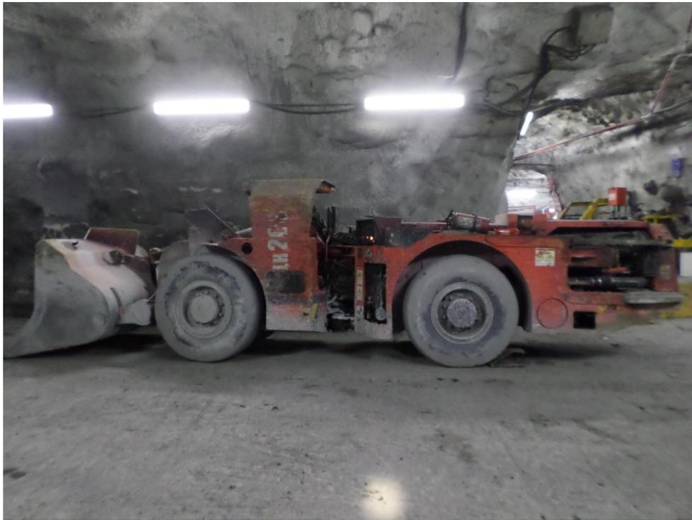
*Fig. 6. Cargador frontal modelo Sandvik LH202.*
