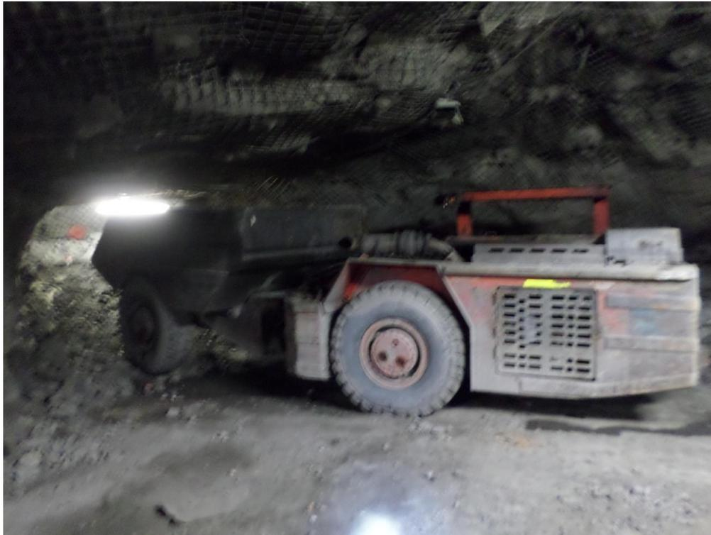
*Fig. 13. Camión de bajo perfil modelo Sandvik TH315.*
