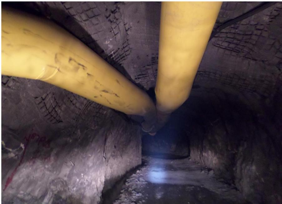
*Fig. 12. Mangas de ventilación en mina Candelaria.*
