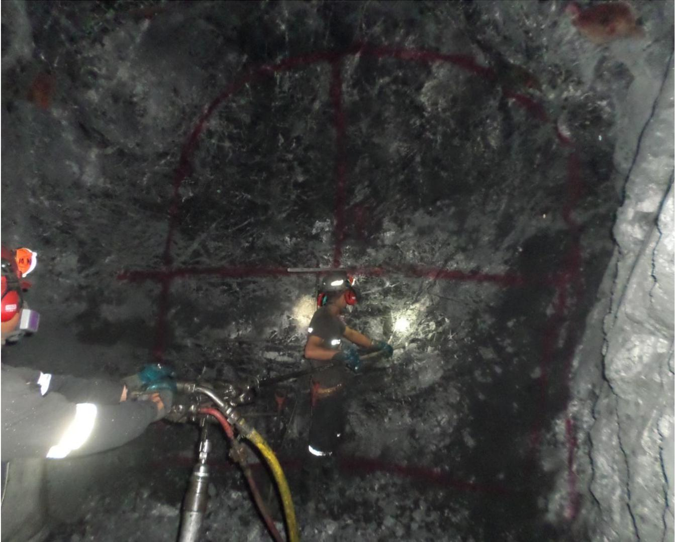
*Fig. 14. Barrenación con máquina de pierna neumática en rampa.*
