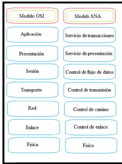
Figura 3.2 Modelo OSI &amp; Modelo SNA.
