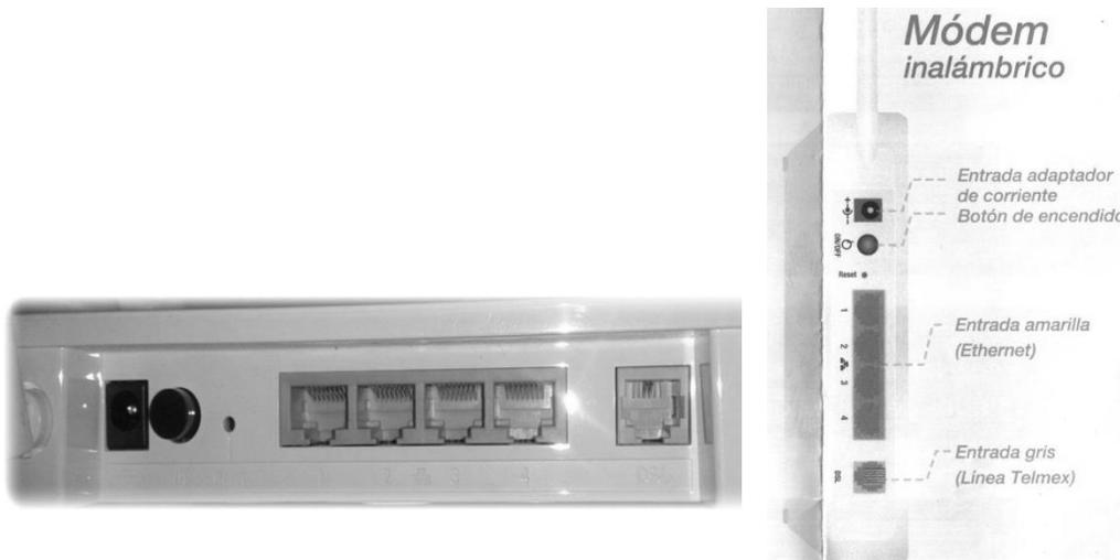
Ilustración 2.6. Puertos de conexión de entrada/salida<sup>5</sup>.
