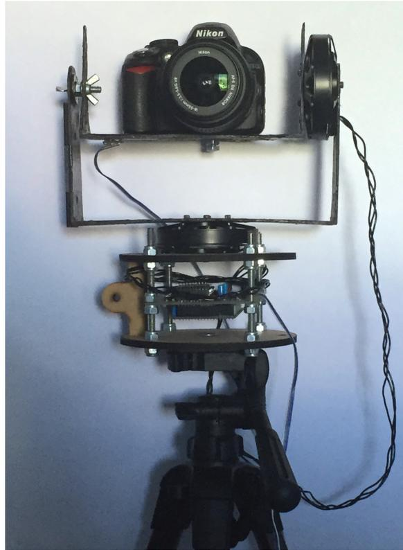
Figura 98. Modelo funcional en modo *time-lapse*.
