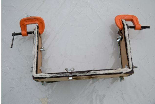
Figura 85. Molde sellado del perfil Roll.
