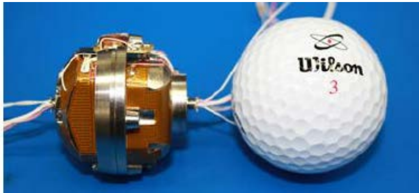
Figura 37. Sensor del Graviglog (Nind et al, 2013).
