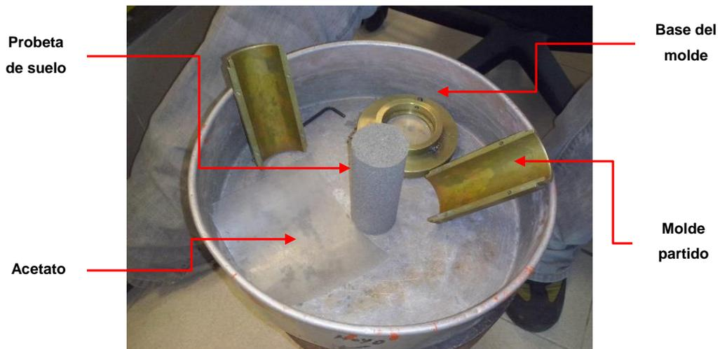
Figura 3.5: Detalles del molde de compactación
