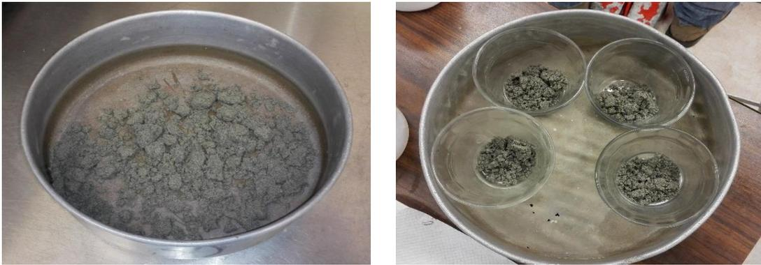
Figura 3.4: Preparación del material para compactación
