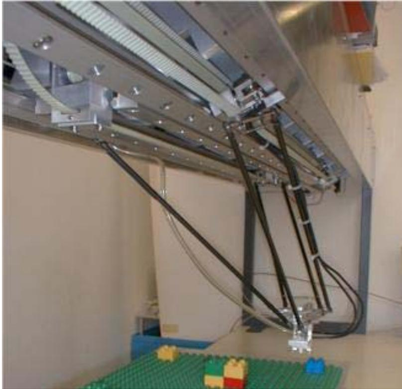
Figura I.9 Robot delta con actuadores lineales.
