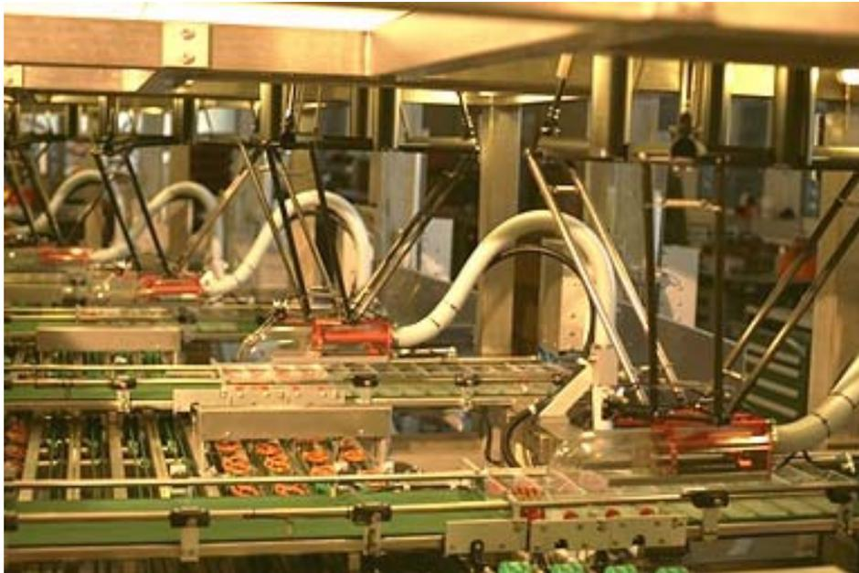
Figura I.3 Instalación Line-Placer para el empaquetamiento de bocadillos (Bretzels).
