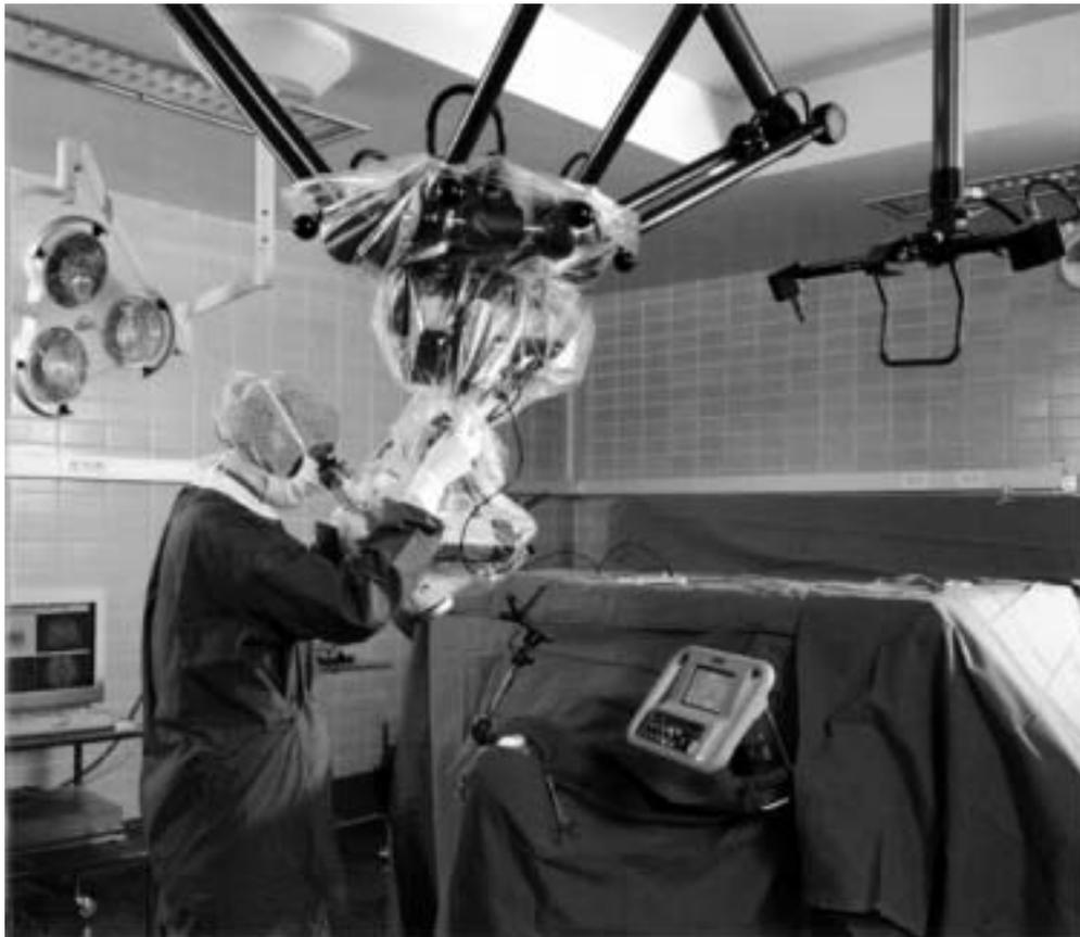
Figura I.11 Robot delta utilizado en aplicación quirúrgica.
