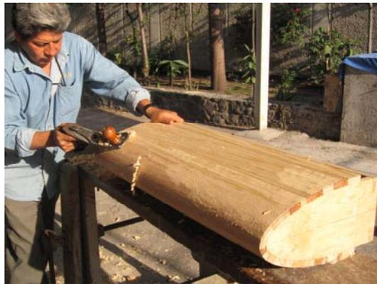
**Fig. IV.7.-** Molde para la fabricación de la estructura receptora
