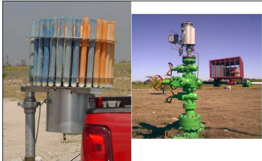
Figura 4.14 Lanzador de Barras Espumantes 18
