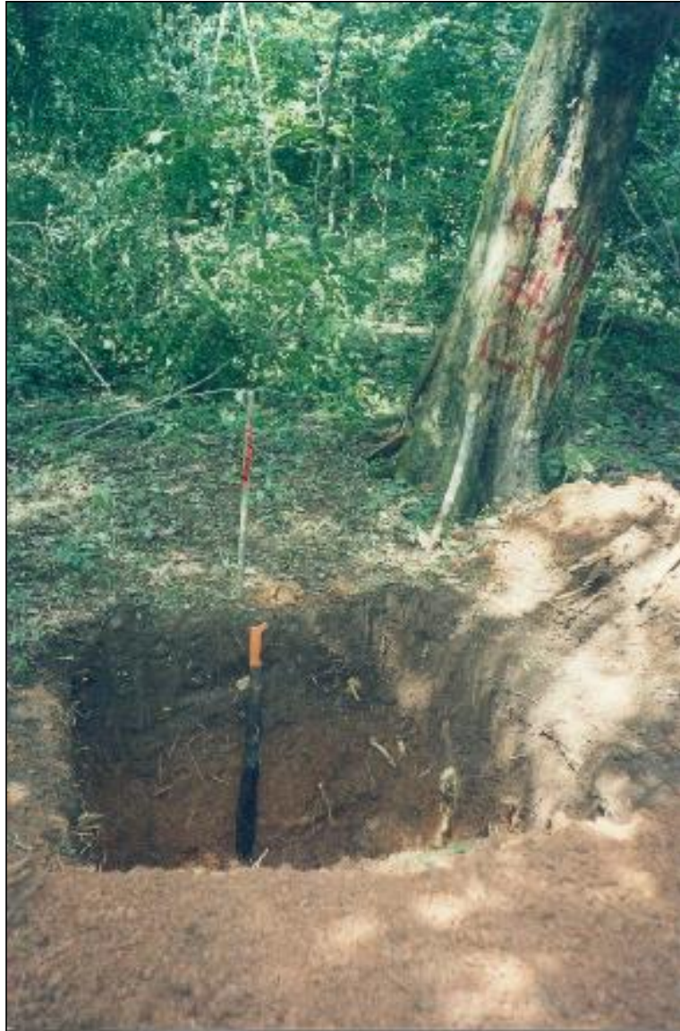
Fotografía 3.1 Pozo a cielo abierto ejecutados en el banco La Sanguijuela I.
