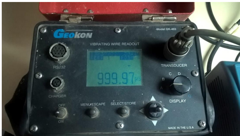
Figura 4.4 Dispositivo Geokon leyendo la Señal Patrón
