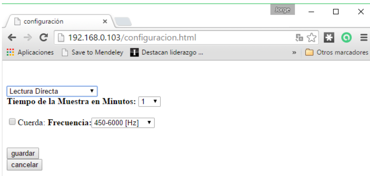
Figura 3.28 Creación de los Controles para Configurar la lectura de una Cuerda Vibrante
