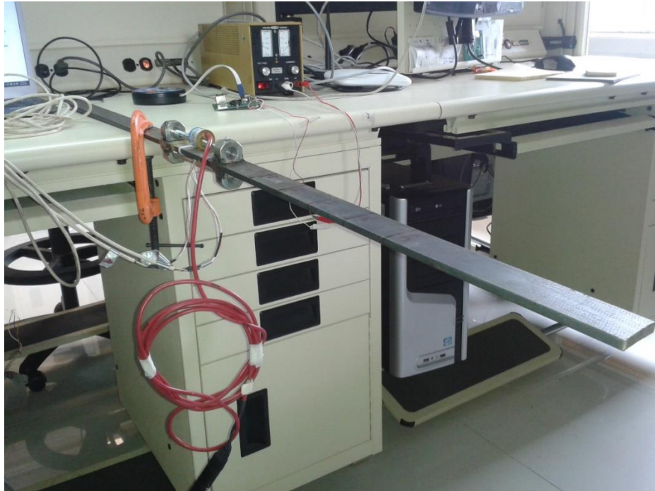
Figura 4.5 Cuerda Vibrante Fijada a una barra de acero
