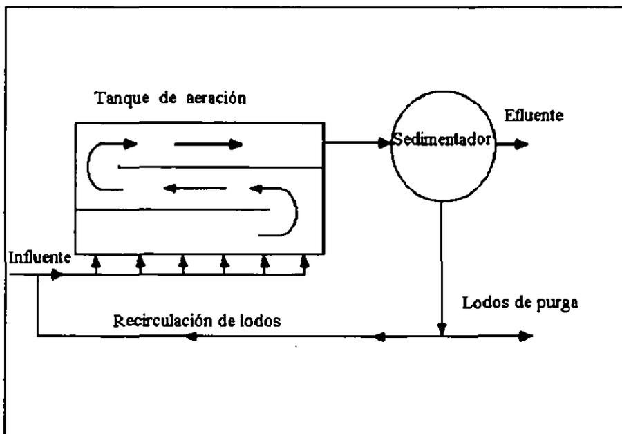
**FIG 1.6 Diagrama de flujo para la modalidad de alimentación escalonada**
