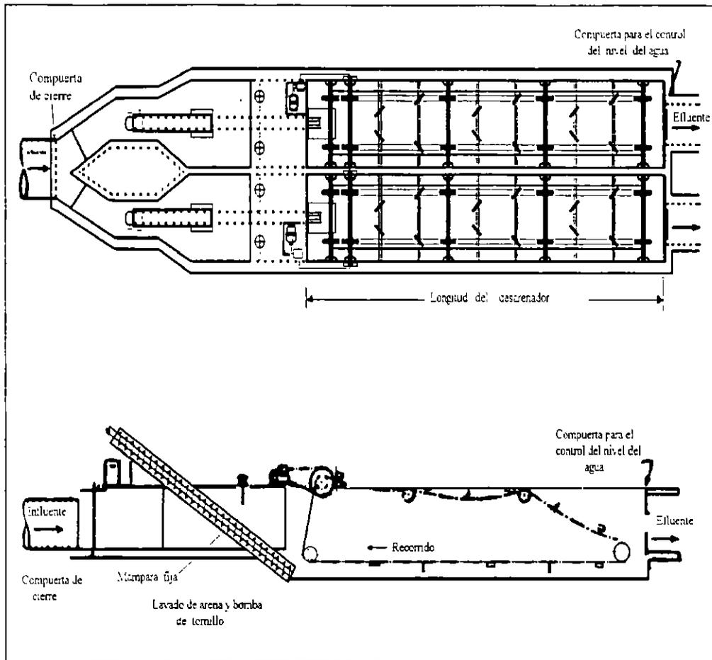
**FIG 2.2** Planta y sección longitudinal de un desarenador de doble canal con depósito.
