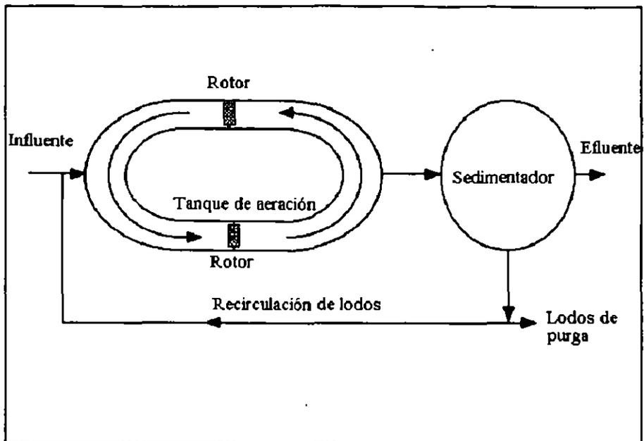
**FIG 1.5 Diagrama de flujo de una zanja de oxidación**
