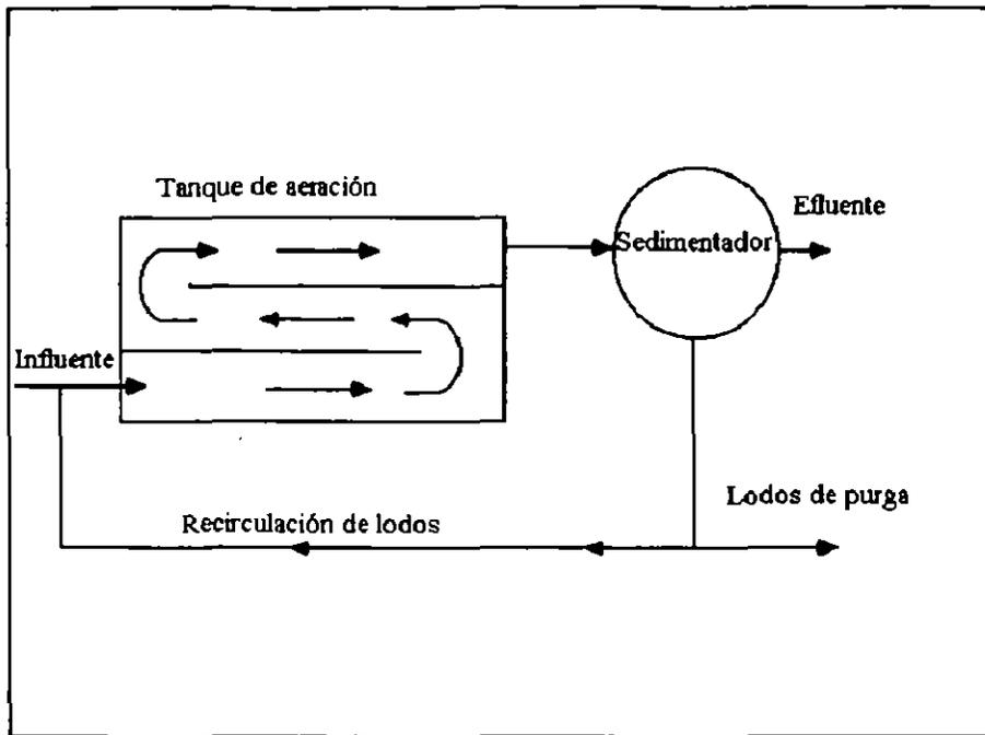
**FIG 1.2 Diagrama de flujo para la modalidad de flujo pistón (convencional)**
