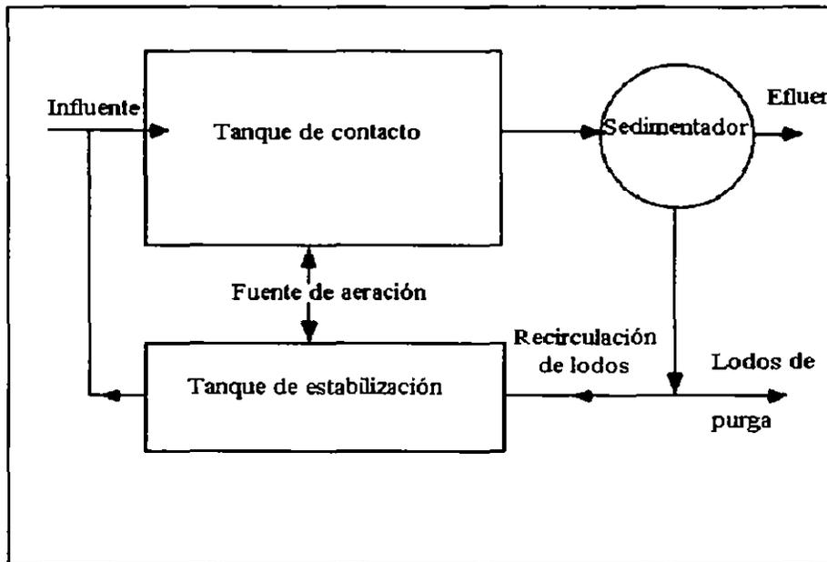
**FIG 1.4 Diagrama de flujo para la modalidad estabilización-contacto**
