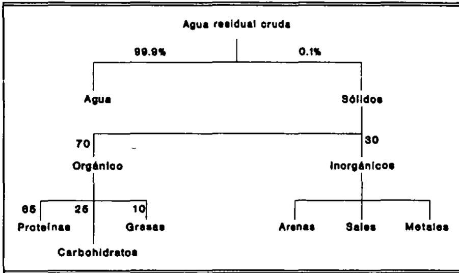
**FIG. 1.3 Composición del agua residual**
