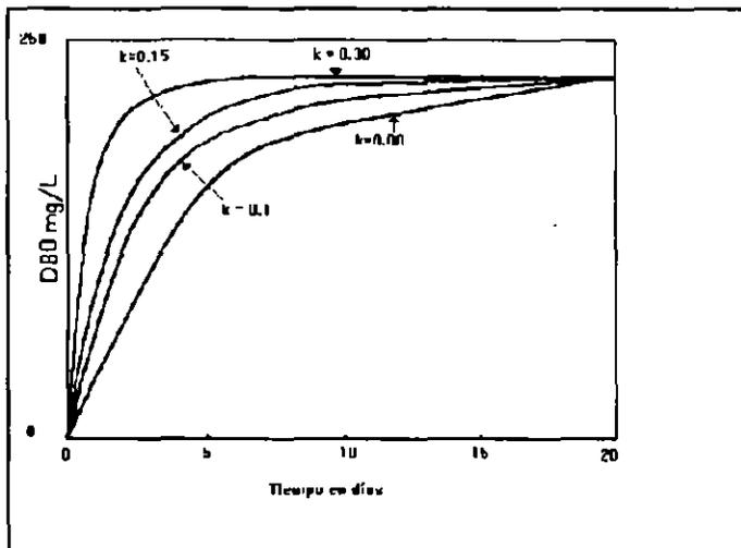
**FIG 2.1 Comportamiento de la DBO con distintas constantes (k depende la temperatura).**
