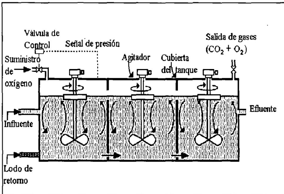
**FIG 1.8** Tanque de lodos activados en la modalidad de oxígeno puro.
