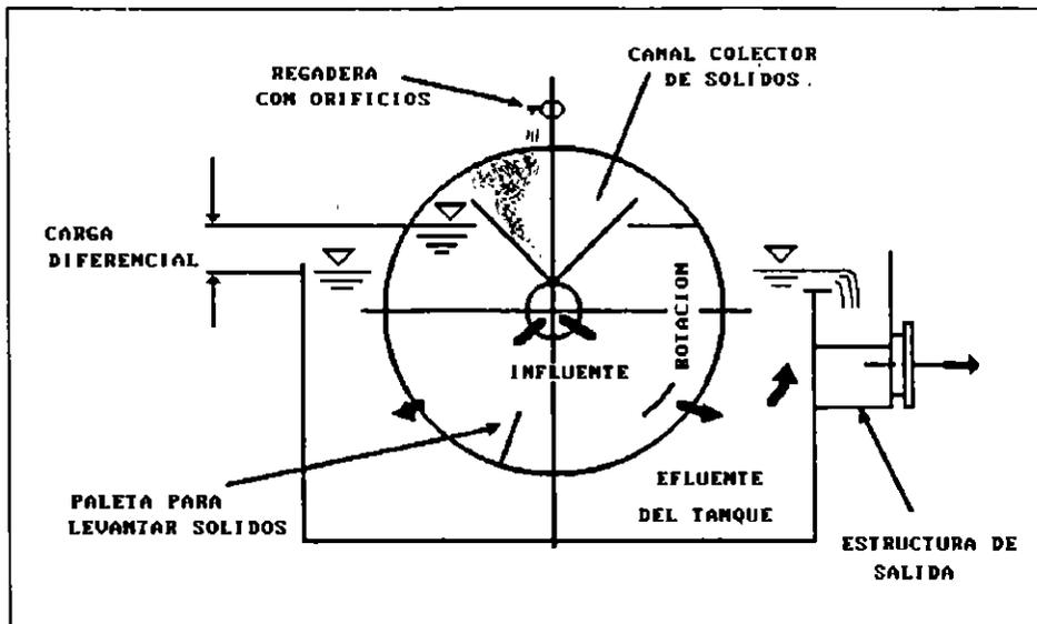
**FIG 1.3** Sección de un tamiz para partículas finas.
