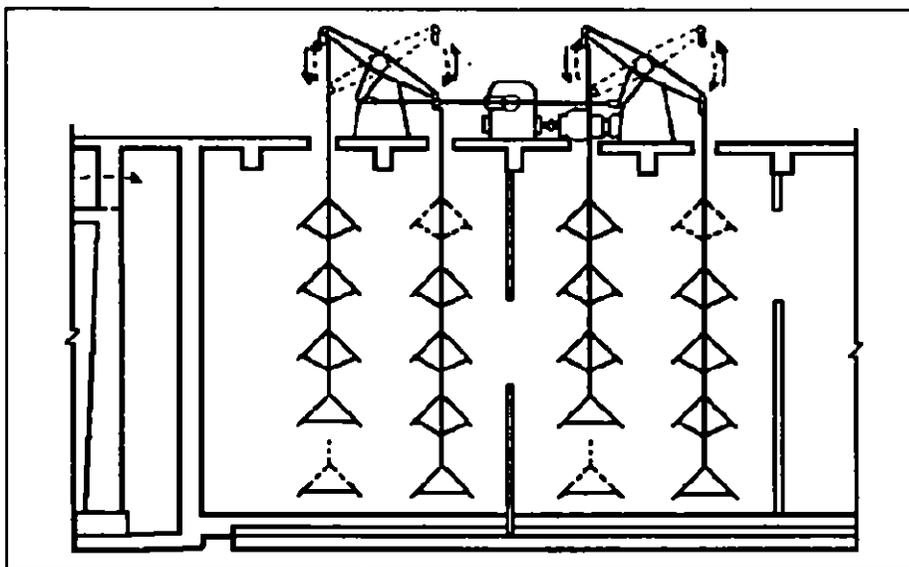
**FIG 1.6 Floculador de tipo oscilatorio (diseño de vigas).**
