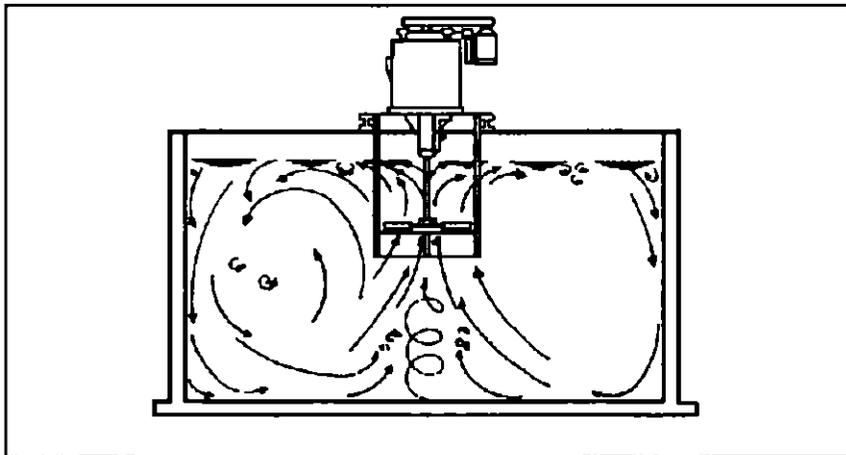
**FIG 1.9 Floculador de turbina montado verticalmente.**
