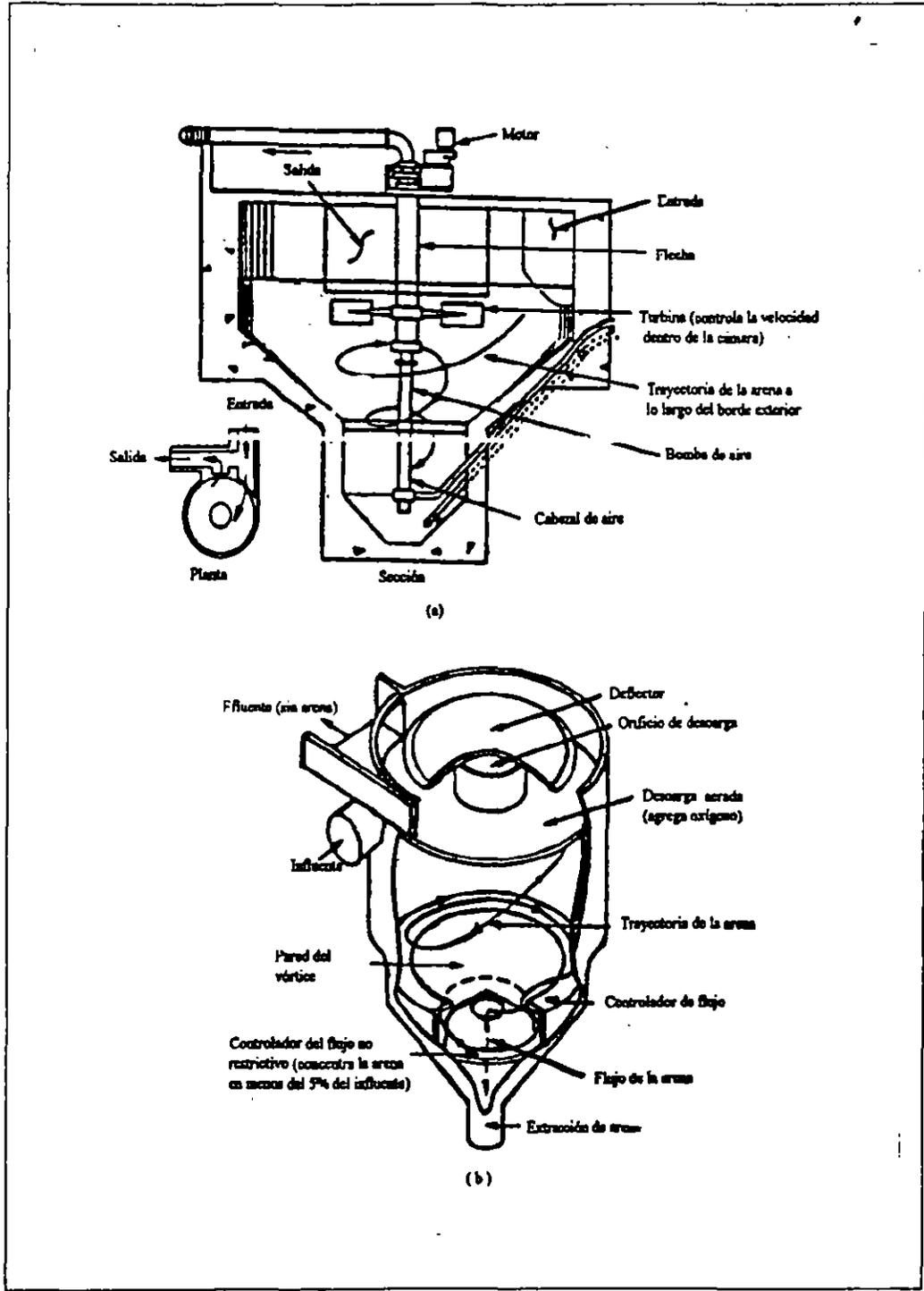
**FIG. 2.5 Desarenadores tipo vórtice: a) unidad PISTA (de Smith & Loveless) y b) unidad taza de té (de Eutek).
