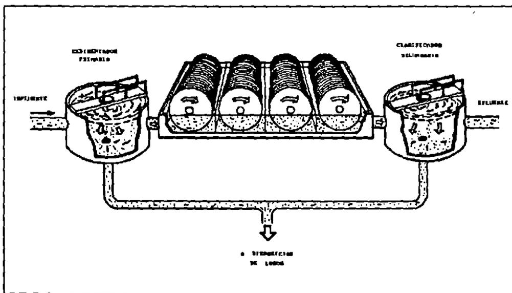
**FIG 3.1 Sistema de biodiscos**
