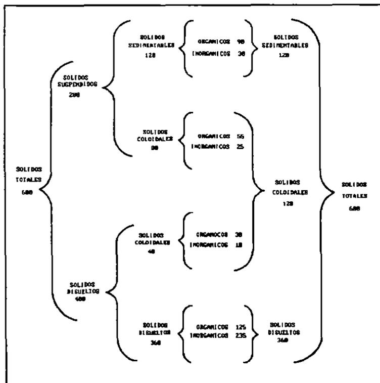
**FIG 1.4** Condición física y composición de los sólidos contenidos en un agua residual doméstica (cifras en ppm).
