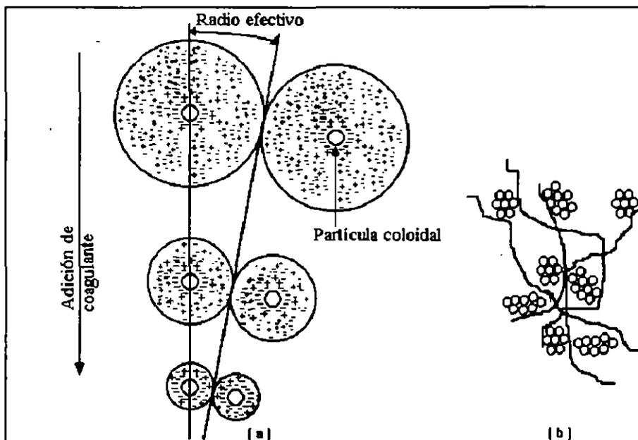
**FIG. 1.1** (a) Coagulación: la adición de coagulante neutraliza las cargas de las partículas y comprime la "nube" que rodea a los coloides de tal forma que se pueden aglomerar.
