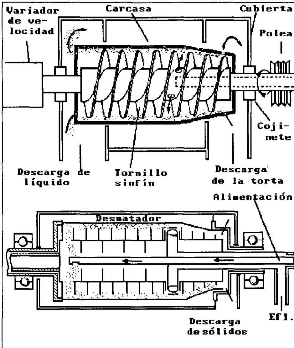
FIG 2.11 Esquema de centrífuga de tornillo sinfín.
