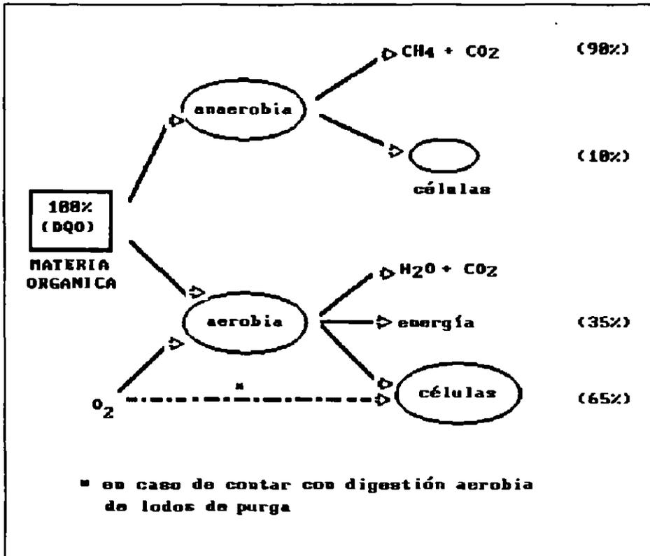
**FIG 5.1 Esquema del flujo de energía de los procesos biológicos de tratamiento de aguas residuales.**
