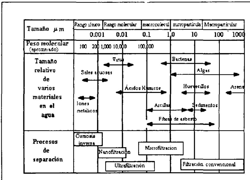
FIG 4.1. Procesos de separación en el tratamiento del agua
