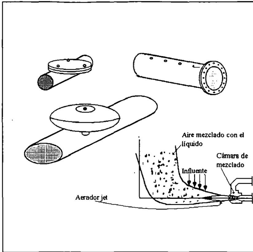
**FIG. 1.10 Difusores empleados en los tanques de aeración.**
