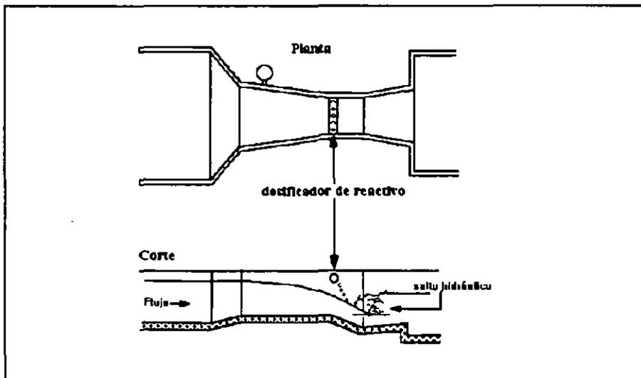
FIG. 1.4 Mezcla por salto hidráulico en un canal parshall
