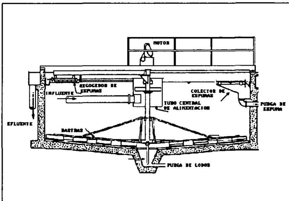
FIG 3.4 Esquema de un sedimentador circular
