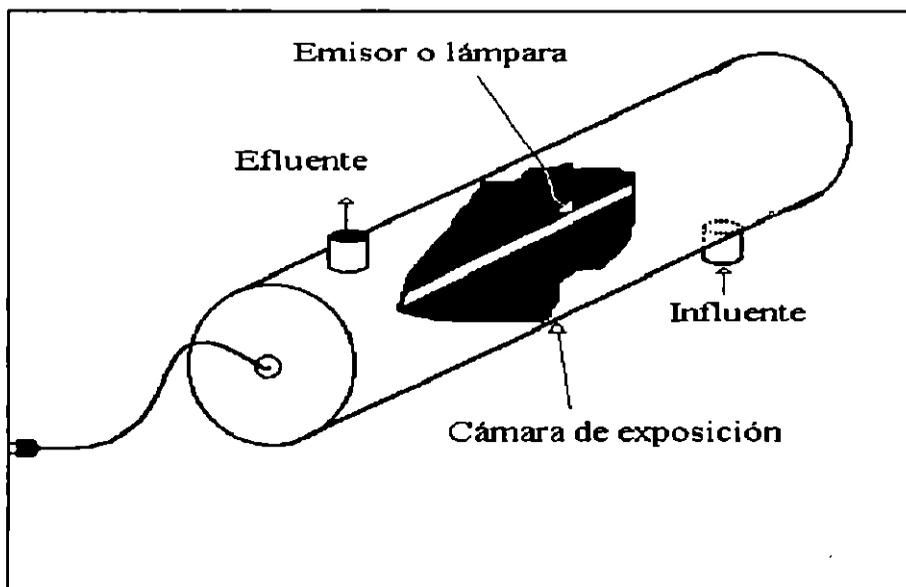
**FIG 3.2** Equipo de desinfección de luz ultravioleta en cámara cerrada
