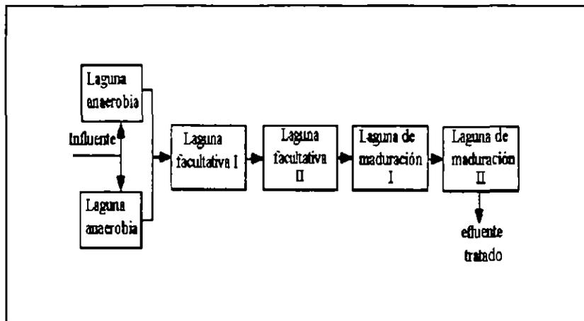
**FIG. 4.2. Esquema típico de un sistema lagunar**
