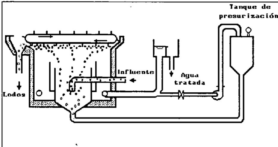
**FIG 2.4** Sistema de flotación para la separación de lodos
