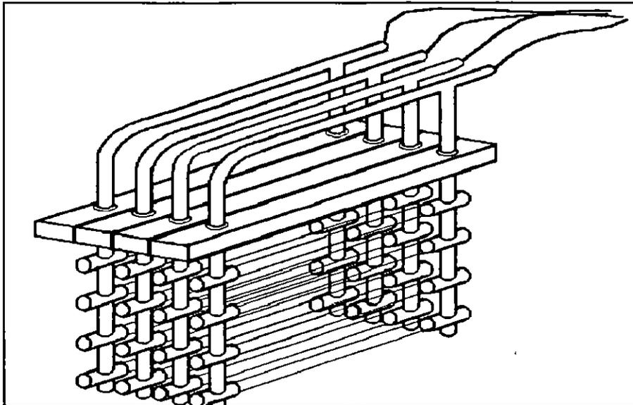
**FIG 3.3** Equipo de desinfección con luz UV para canal
