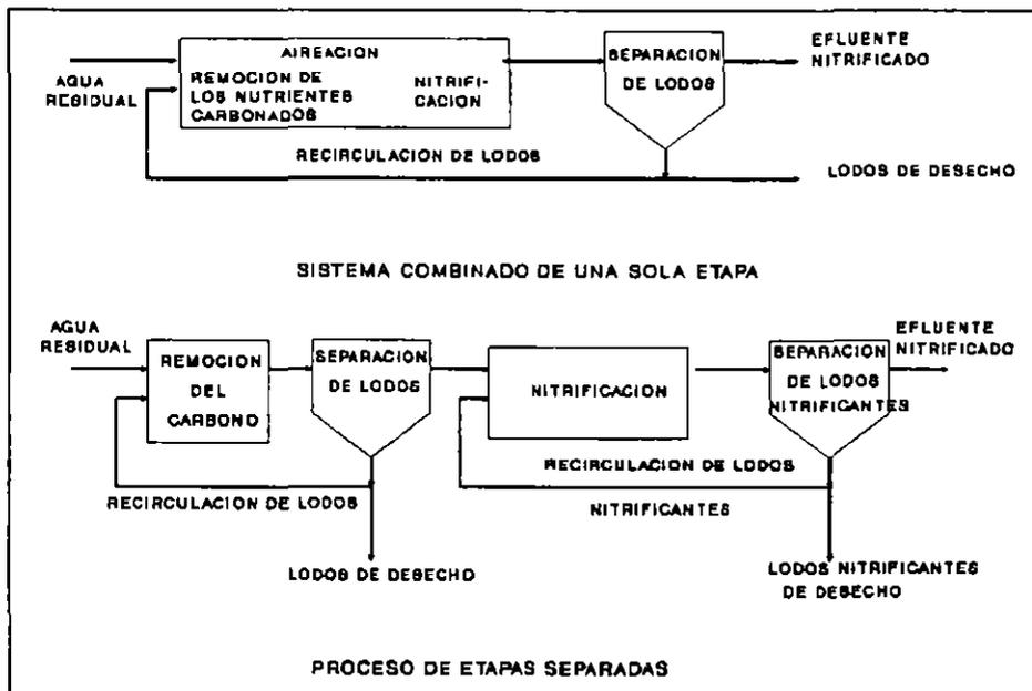
**FIG 6.1** Esquemas de procesos para la nitrificación y remoción de los nutrientes carbonados.
