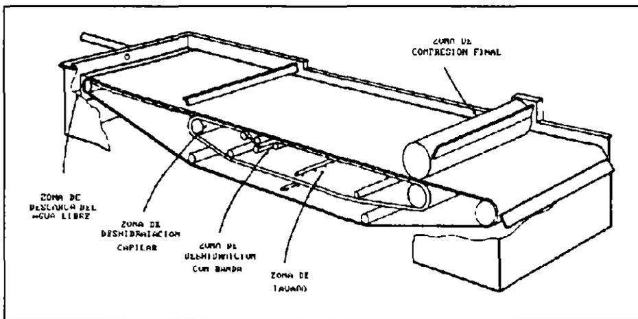
**FIG 2.9 Unidad de deshidratación capilar**
