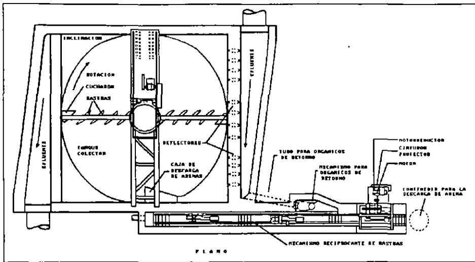
**FIG 2.4 Vista en planta de un tanque desarenador a nivel constante.**
