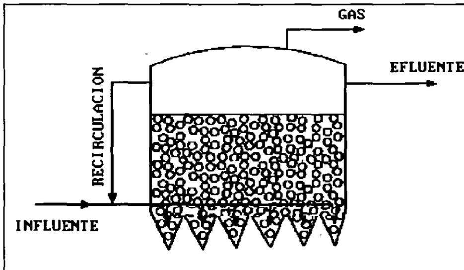
FIG 5.5 Reactor de lecho expandido
