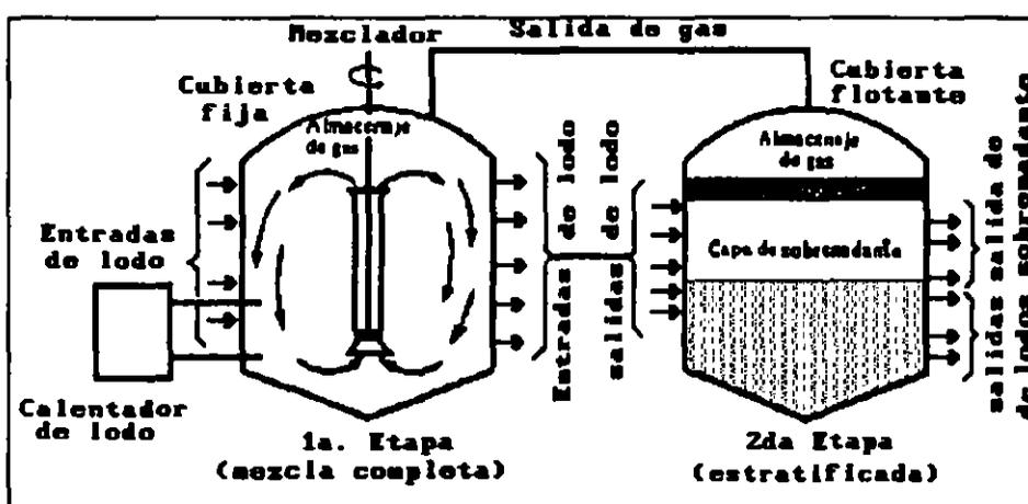
FIG 2.5 Digestor anaerobio de dos etapas
