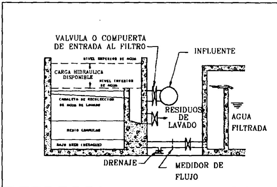
**FIG 4.3 Filtro granular profundo**
