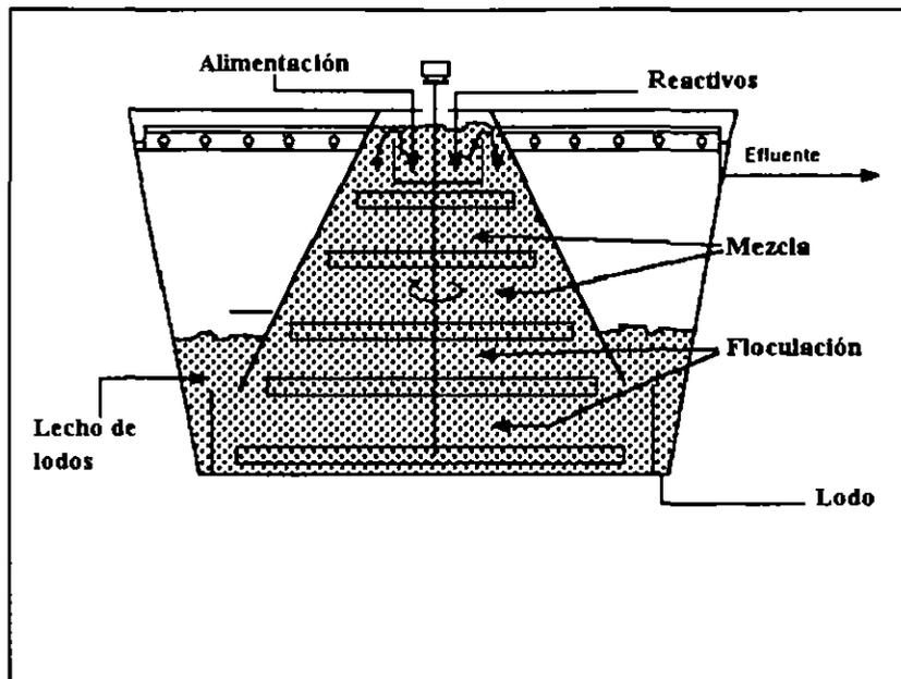
**FIG. 1.11** Unidad de contacto de sólidos del tipo filtración por manto de lodos.
