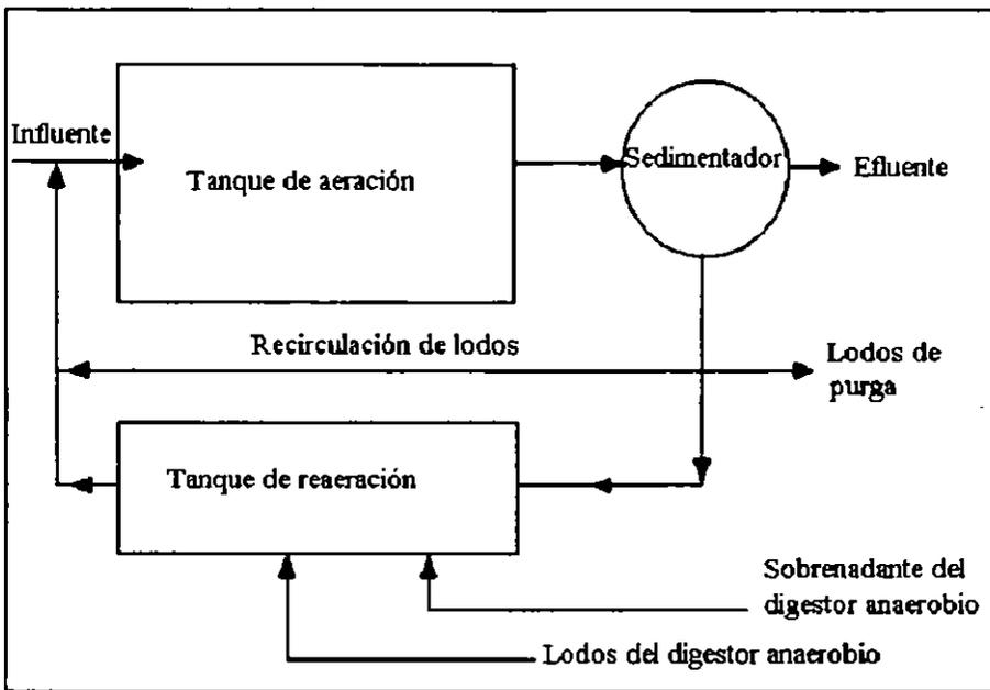
**FIG 1.9 Diagrama de flujo para el proceso de Kraus**
