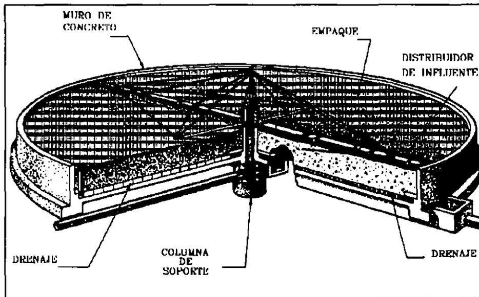
**FIG 2.1 Esquema de un filtro percolador.**
