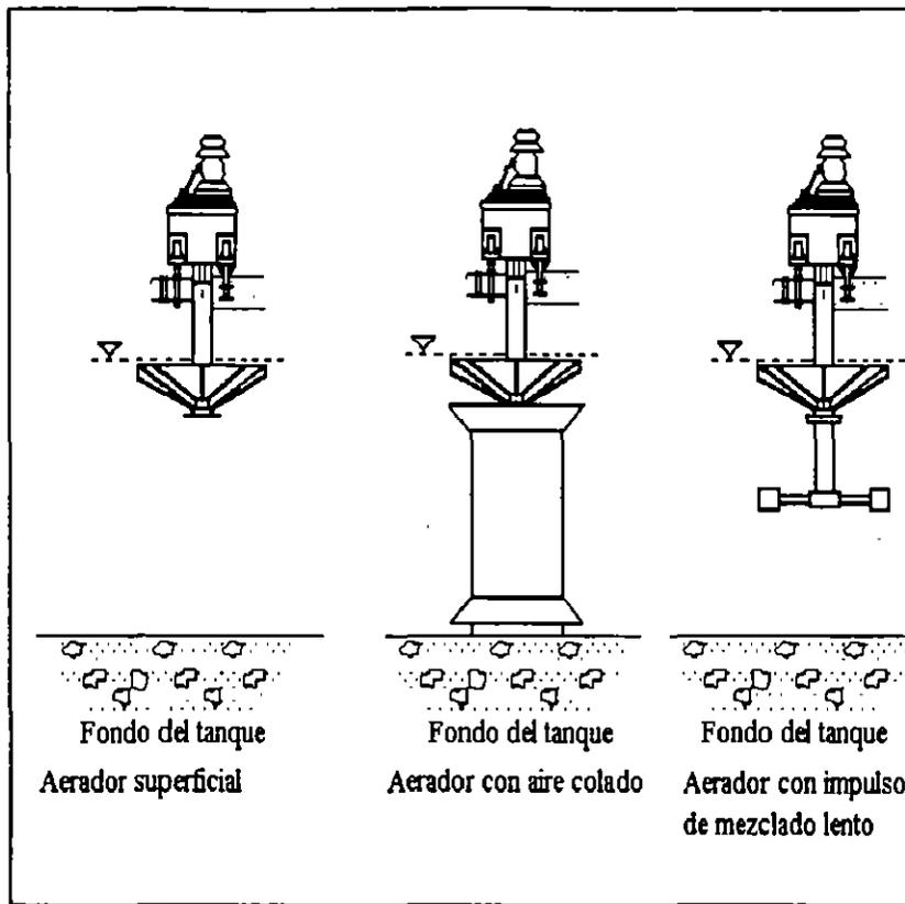
**FIG 1.12 Aeradores sumergidos de turbina.**
