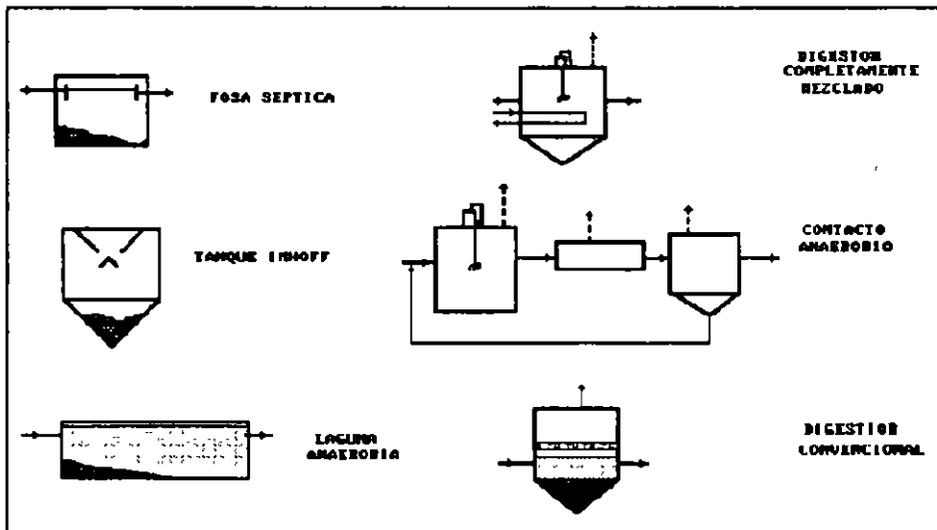
FIG 5.2 Reactores anaerobios de la 1ª generación.
