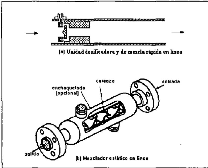
FIG. 1.3 Mezcladores en línea: a) unidad dosificadora y de mezcla rápida en línea, b) mezclador estático
