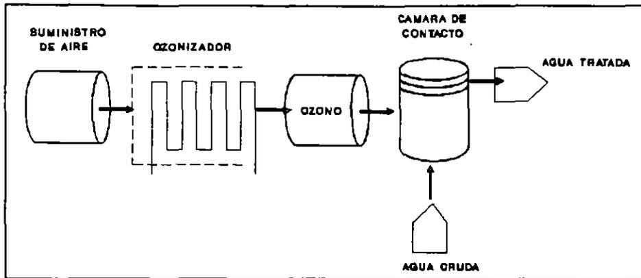
**FIG 3.1 Esquema de la desinfección mediante ozonación**
