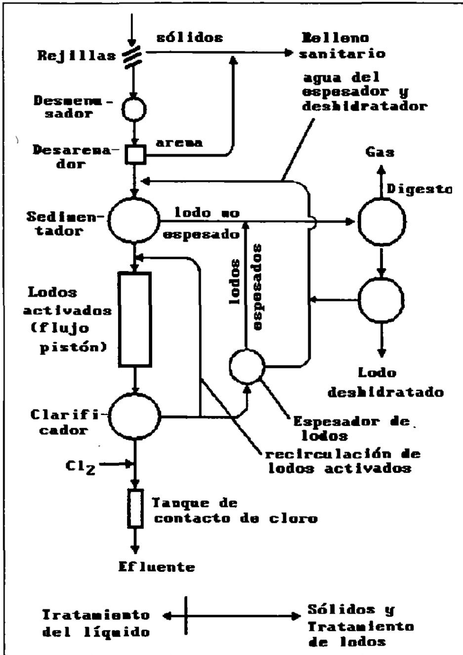
FIG 4.2 Diagrama de flujo típico de una planta de tratamiento instalada en comunidades grandes. La planta utiliza el sistema de lodos activados como tratamiento biológico
