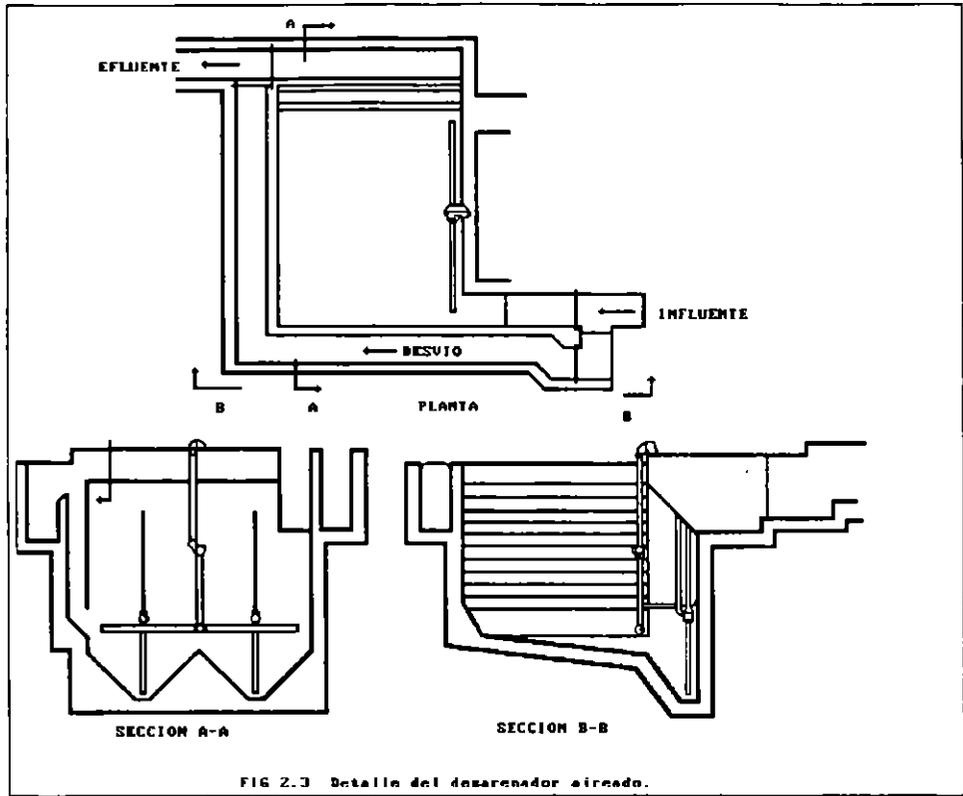
FIG 2.3 Detalle del desarenador aerado.
