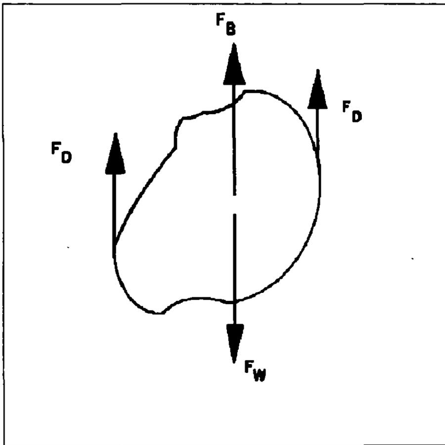
**FIG 3.2** Diagrama de cuerpo libre para la decantación de una partícula.
