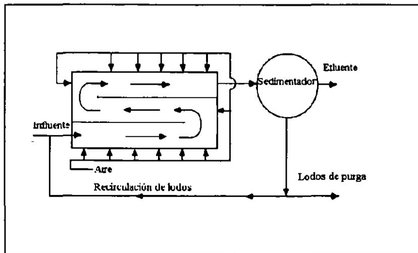
**FIG 1.7 Diagrama de flujo para la modalidad de aeración reducida.**
