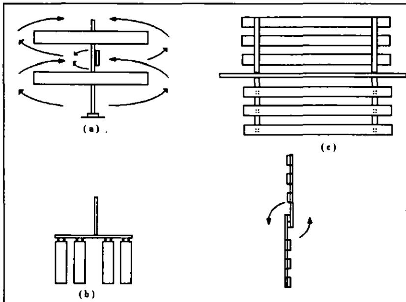
**FIG 1.7 Distintos tipos de paletas: a) paletas radiales, b) paletas axiales y c) rieles o paletas axiales**
