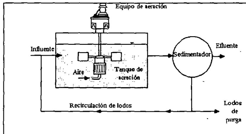
**FIG 1.3 Diagrama de flujo para la modalidad del procesos completamente mezclado.**
