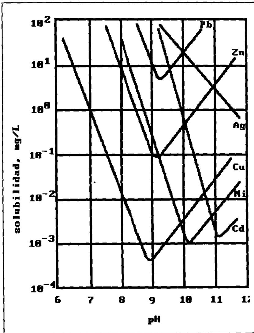
FIG 2.1 Solubilidad de los hidróxidos metálicos en función del pH
