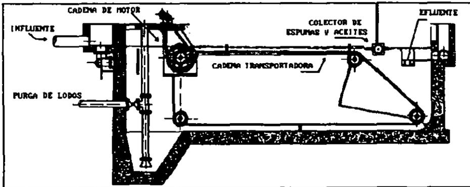
**FIG 3.3 Esquema de un sedimentador rectangular.**
