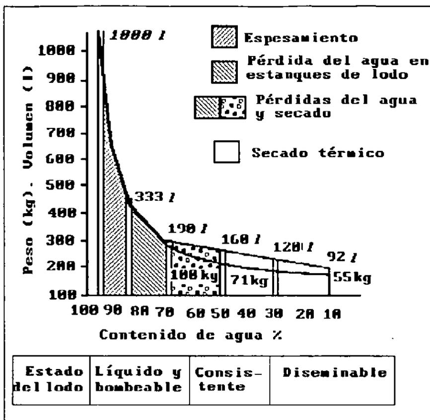
**FIG 2.2** Disminución del peso y volumen del lodo por pérdida de su contenido de agua
