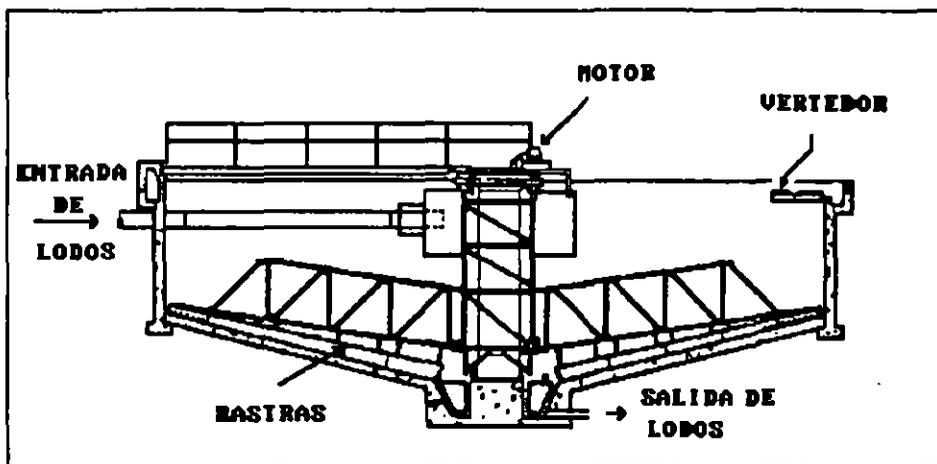
FIG 2.3 Espesador cilíndrico de lodos (sedimentador)
