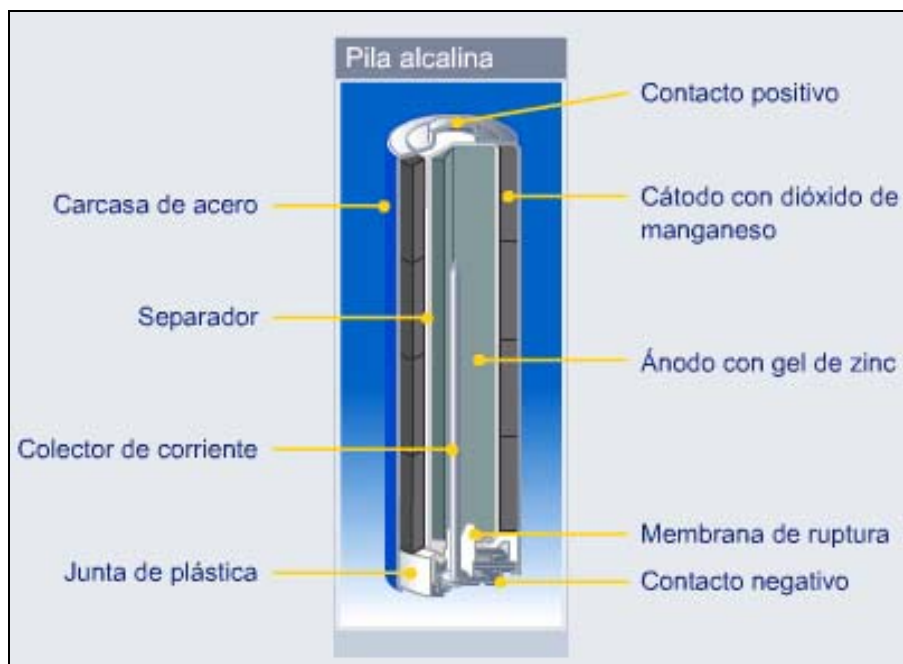
Figura 1.4. Componentes de una pila alcalina.
