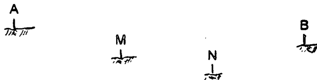
Figura 3.7 Cuadripolo característico para medida de resistividad de la tierra.
