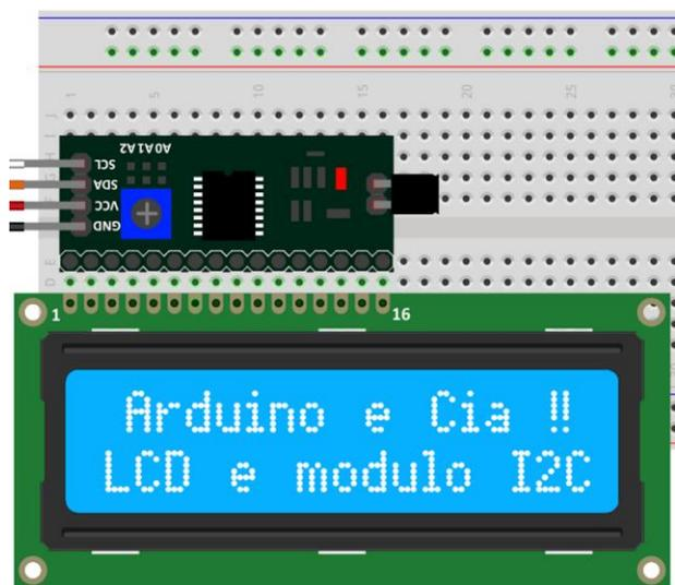
Ilustración 18. Esquema de conexiones de modulo  $I^2C$  a LCD.<sup>23</sup>
