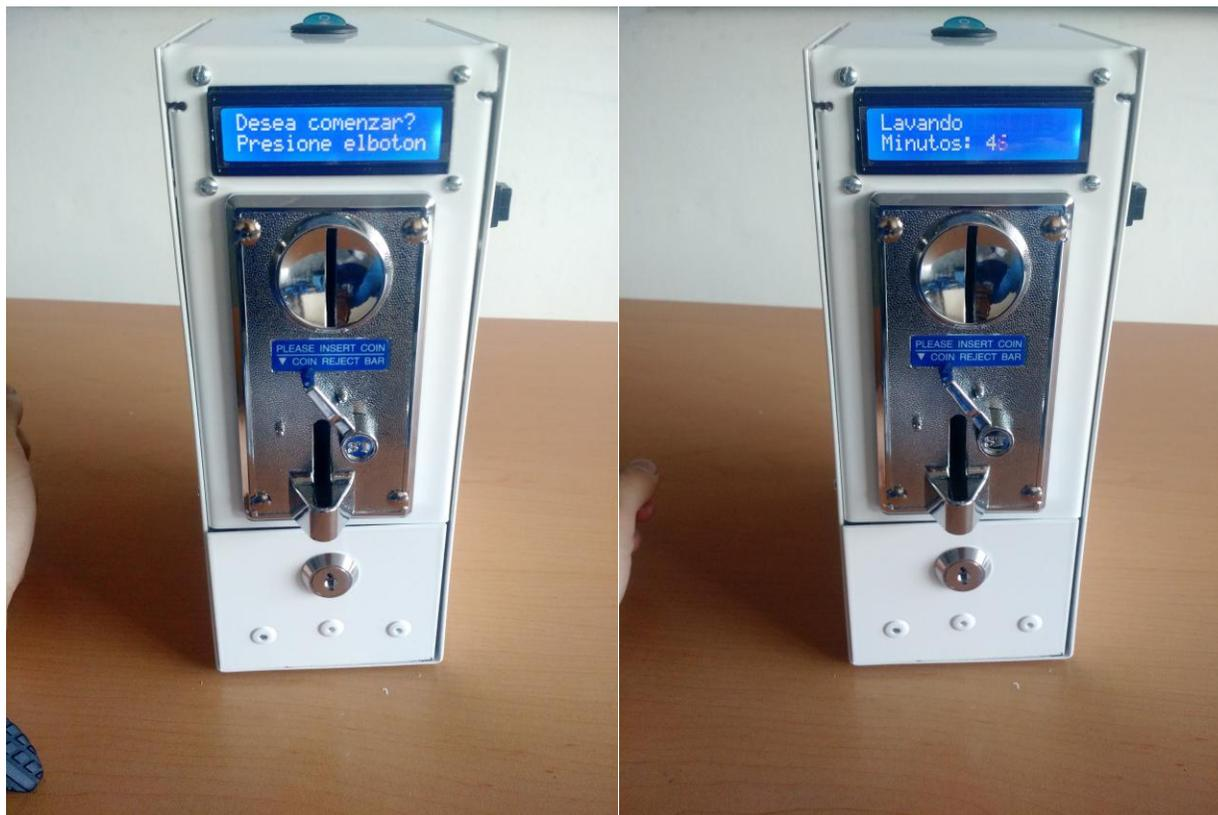
Ilustración 53. Ciclo de trabajo del prototipo, inicio de lavado.<sup>41</sup>
