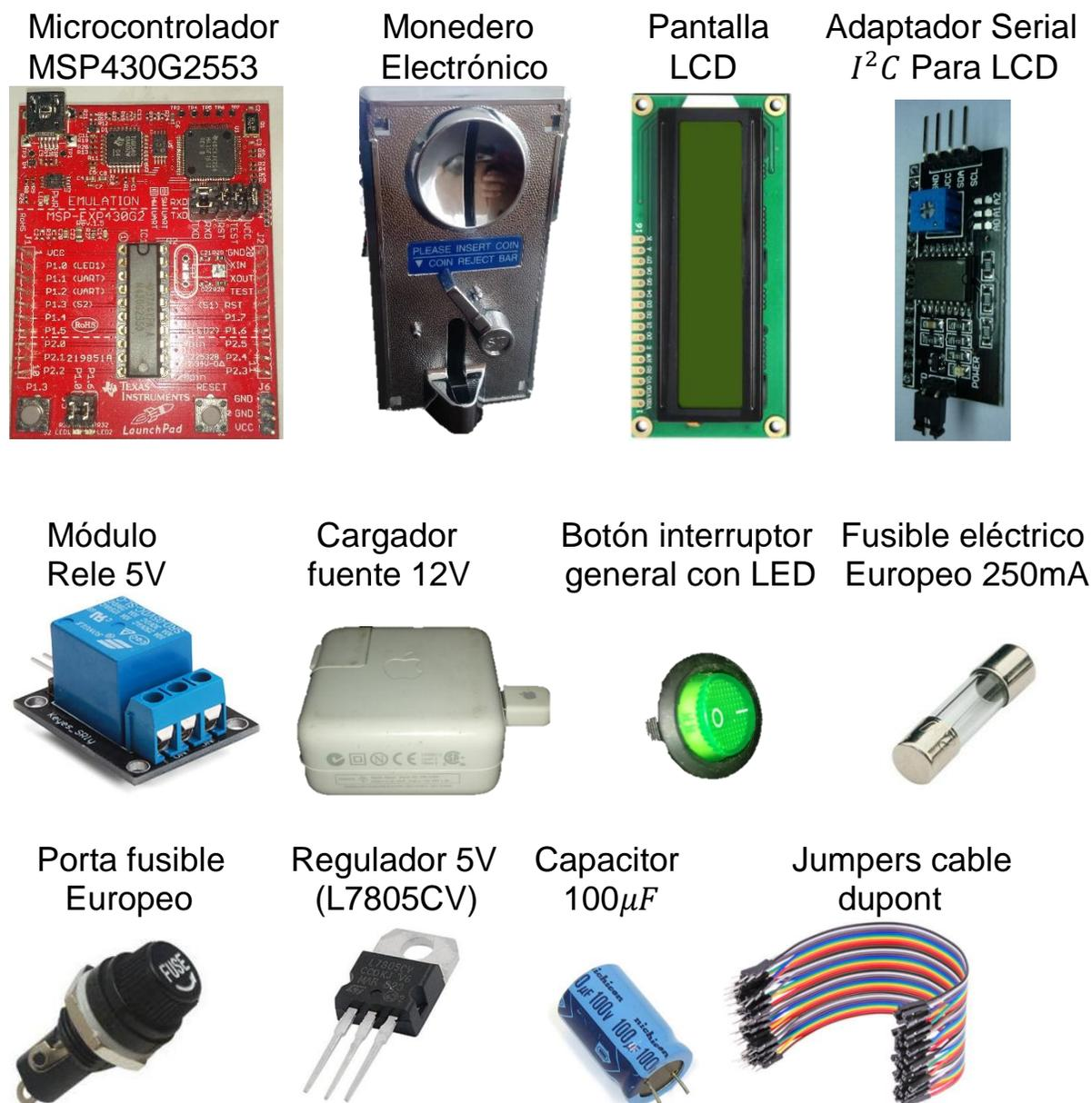
Ilustración 32. Dispositivos electrónicos principales del sistema.<sup>27</sup>
