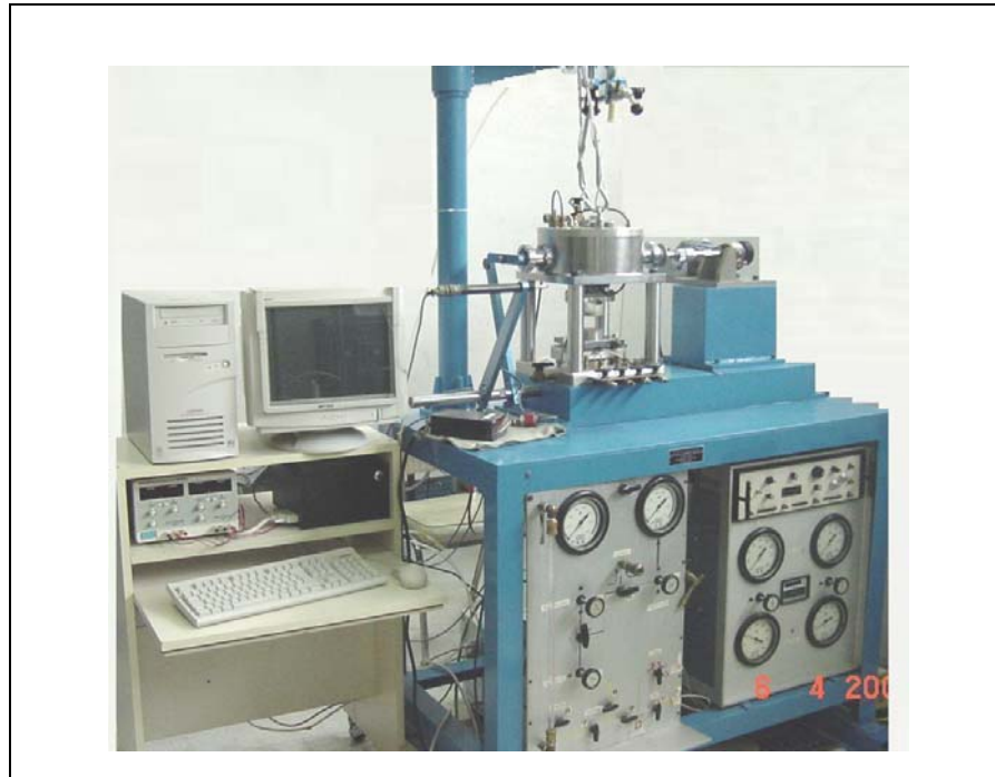
Figura 4.4 Vista general del equipo de corte simple cíclico, tipo NGI (Laboratorio de Dinámica de Suelos. Facultad de Ingeniería. UNAM)
