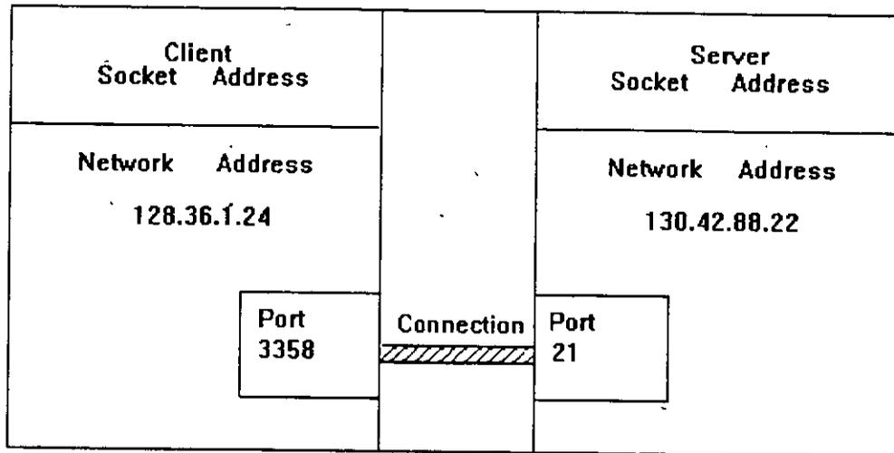
Como los datos para una conexión particular de TCP siempre queda identificada por sus direcciones de IP y sus números de puertos, para el servidor es muy sencillo seguir el rastro de las conexiones de muchos clientes. (fig. 5.4).
