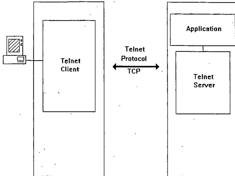
Como se muestra en la (fig. 6.2), un usuario en una terminal interactúa con su proceso local de cliente Telnet. Este cliente intercambia datos con el servidor Telnet remoto mediante una conexión de TCP. El Servidor Telnet interactúa con las aplicaciones emulando una terminal nativa.
