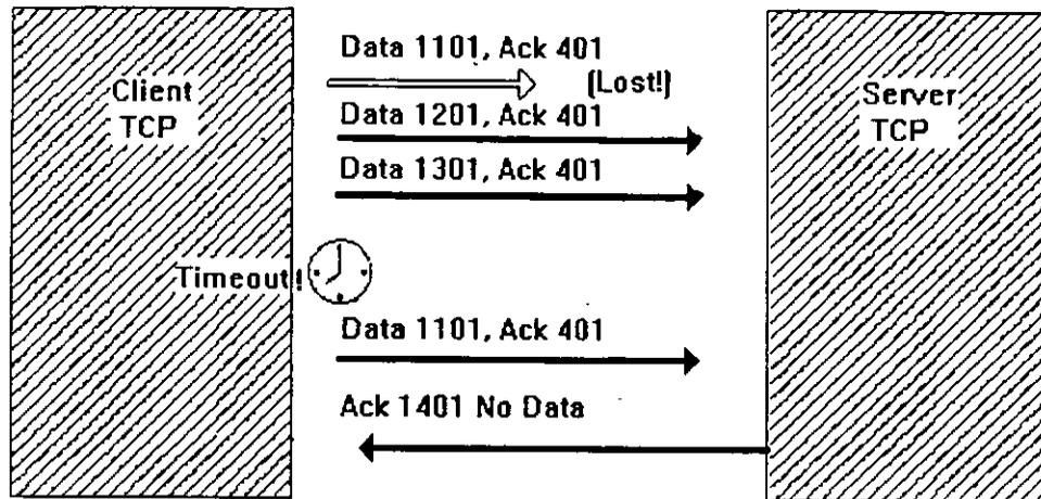
En la (fig. 5.8), se muestra una transferencia de datos en la que se pierde el primer segmento. Después de un cierto intervalo de tiempo el segmento es transmitido nuevamente. Debe observarse que, una vez que el segmento perdido llega a su destino, el receptor envía un ACK que solo confirmará que los tres segmentos llegaron a salvo.
