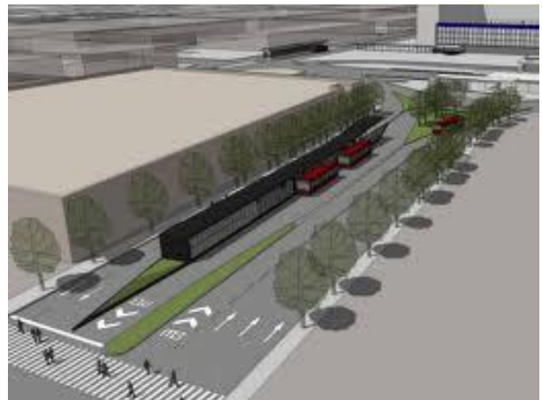
Imagen 3.3.6 Diseño tipo estaciones Metrobús
