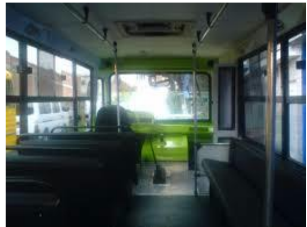
Imagen 3.6.5 Adaptación del interior de un Microbús para ampliar el pasillo
