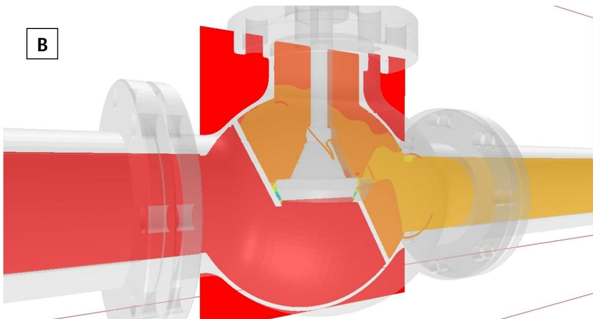
Figura 3.17. Campo de presión: (A) apertura de 0.5 [-], (B) apertura de 0.1 [-] en la válvula.
