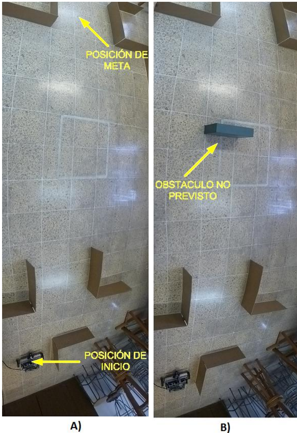
Figura 6-6. Espacio de trabajo sin obstáculo y con un obstáculo no previsto en la planeación previa de trayectorias
