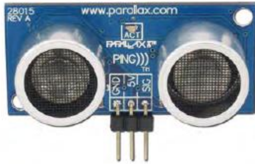
Figura 4-12. Sensor ultrasónico PING))). El sensor posee un sonar que emite ondas ultrasónicas y un micrófono para detectarlas, tiene tres terminales: GND, 5V y SIG para las señales de control.
