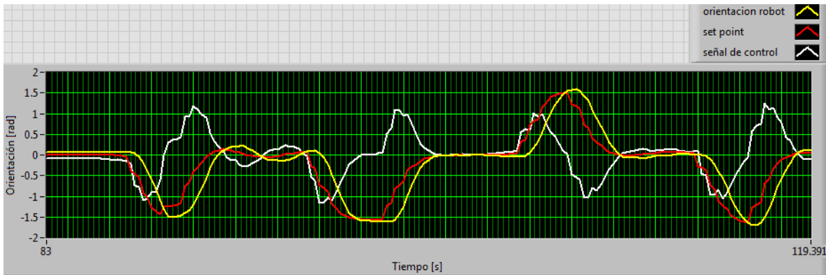
Gráfica 6-11. Variación de la orientación del robot, del comando de orientación y de la señal de control
