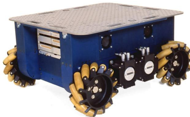
Figura 1-16. El robot Uranus [18] es un robot omnidireccional con cuatro ruedas suecas 45° actuadas
