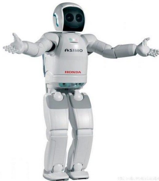
Figura 1-7. El robot Asimo es un robot bípedo que emula el sistema de locomoción humana
