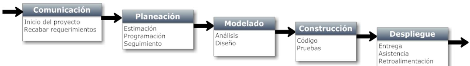
*Figura 2. Modelo del ciclo de vida en cascada<sup>11</sup>.*
