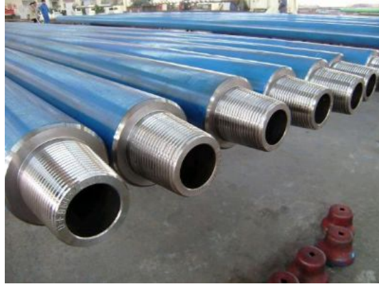
Figura 3 Tubería de perforación
