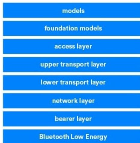
Figura 11. Pila del protocolo Bluetooth Mesh.<sup>8</sup>
