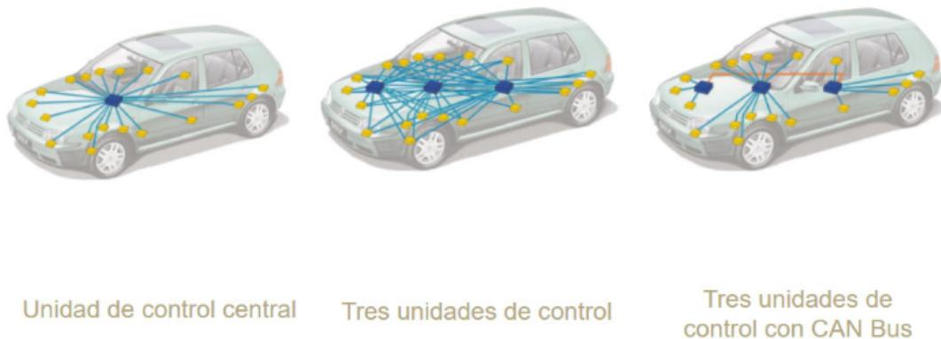
Figura 13. Comparativa del uso de CAN bus. <sup>1</sup>
