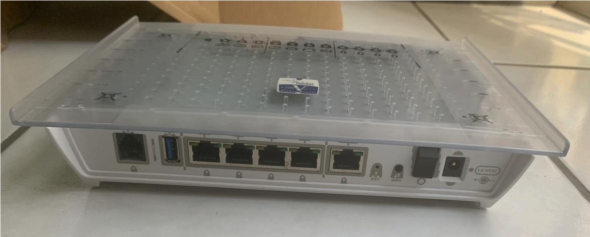
*Figura 34. Router Teldat V vista trasera.*
