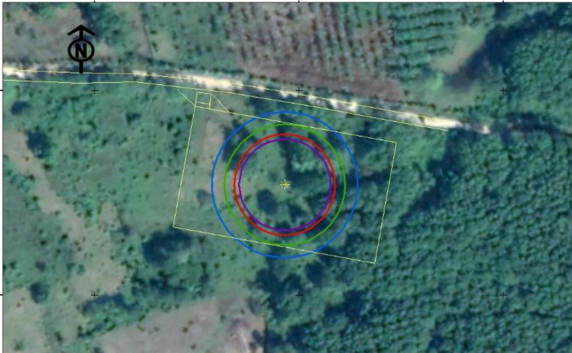
**Figura 5.17** Radios de afectación para el escenario de descontrol (falta de preventores)
