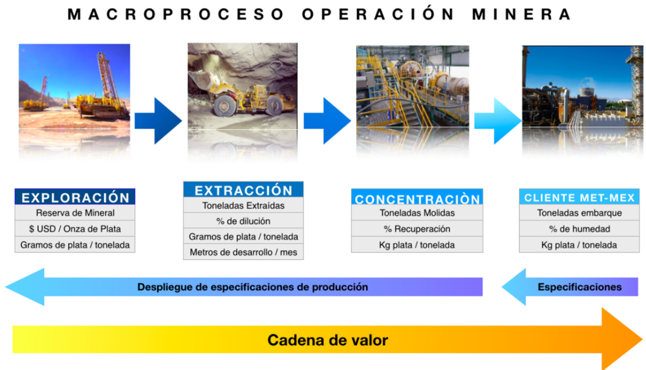
FIGURA 4.1: Esquema del macroproceso de operación minera en Minera Fresnillo.
