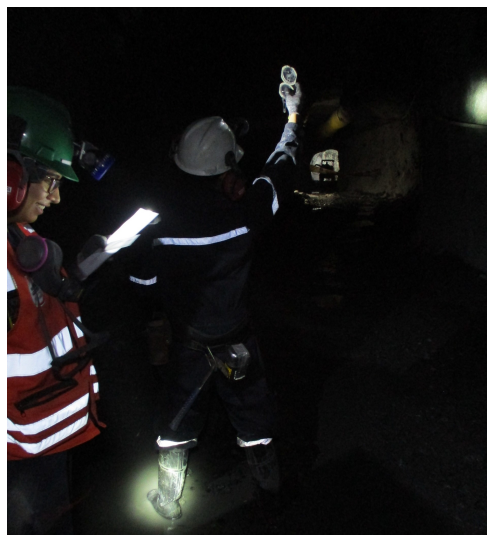
FIGURA 5.7: Toma del dato y registro del ángulo de inclinación de la estructura mineralizada.
