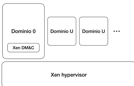
Figura 2.2: Elementos que componen a Xen.
