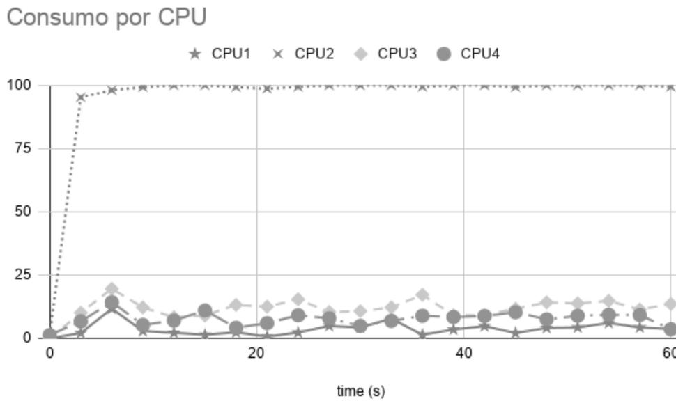
Figura 5.7: Porcentaje de uso de CPU por núcleo con paquetes de 12000 bytes.
