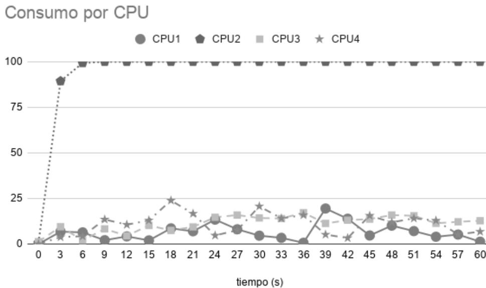
Figura 5.4: Porcentaje de uso de CPU por núcleo con paquetes de 1200 bytes.
