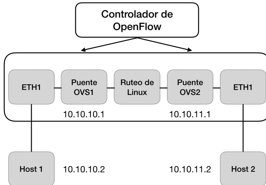
Figura 3.2: Arquitectura implementada de OVS-Xen sobre Debian.
