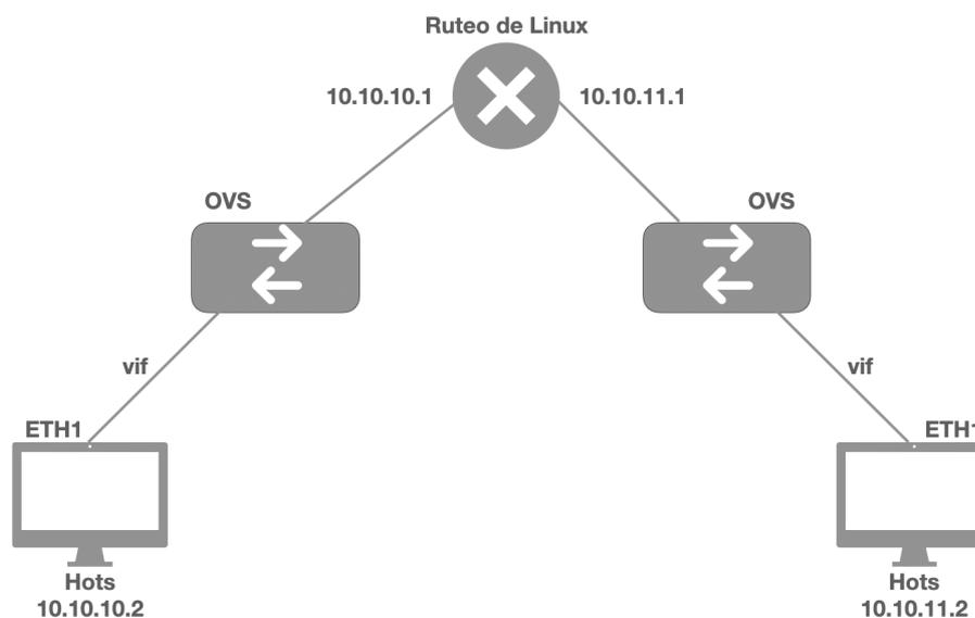
Figura 3.3: Diagrama de la red SDN con equipos reales.
