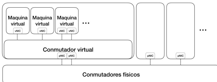
Figura 2.3: Arquitectura general de un conmutador virtual.
