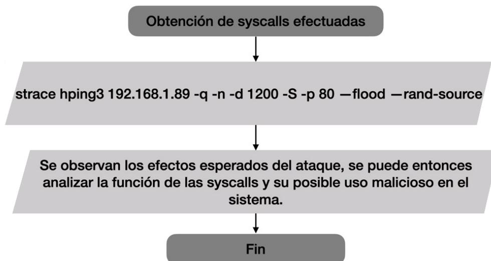
Figura 5.8: Diagrama de extracción de las *syscalls* durante el ataque.
