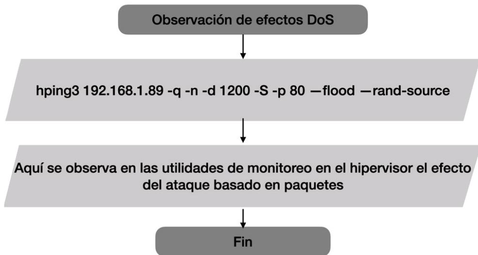
Figura 5.1: Diagrama del proceso de monitorización de los efectos de un DoS.
