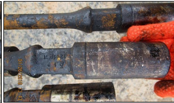
Figura 2.28 Caja de la varilla de bombeo
