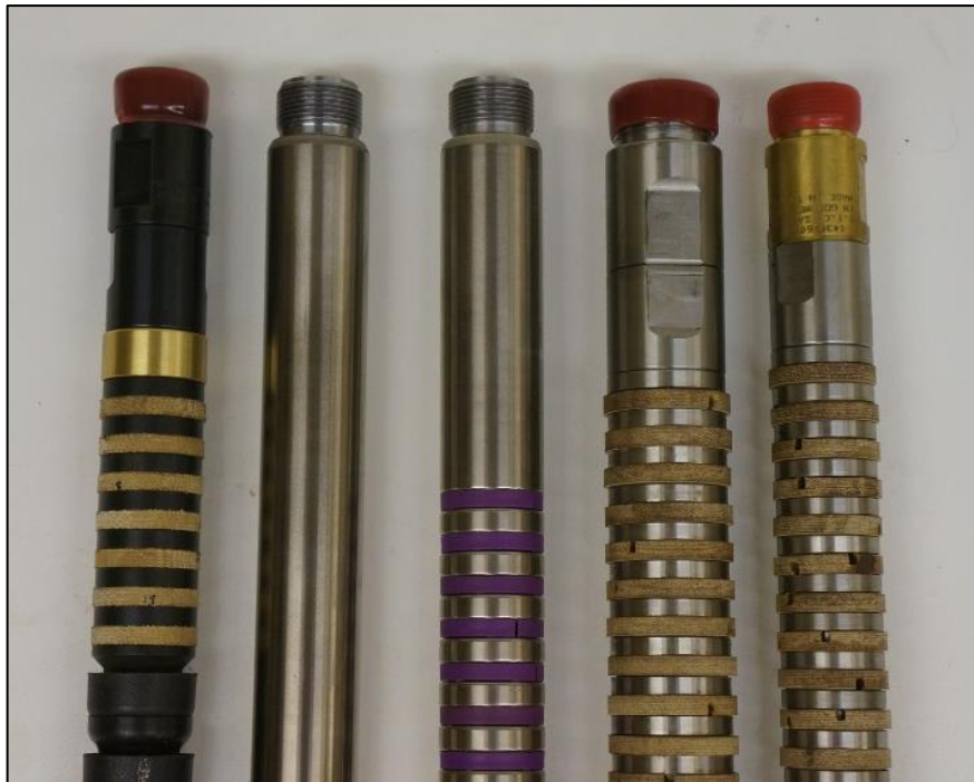
Figura 2.14 Émbolo de la bomba subsuperficial
