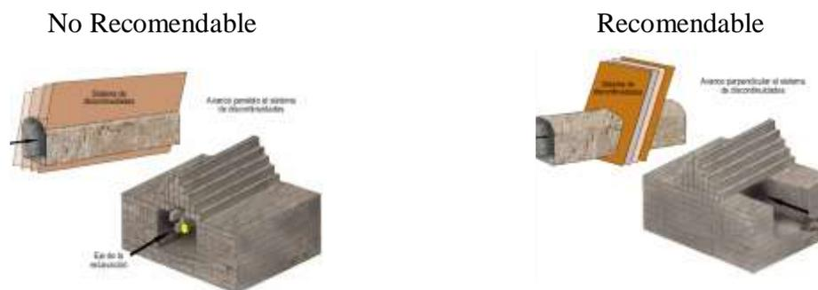
Imagen 65. Las excavaciones son más estables y más controlables al planearlas lo más perpendicularmente la fallamiento o estructuras principales, ya que si las tomamos a rumbo, las cuñas las traeremos a lo largo de toda la obra. [9]
