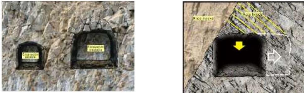
Imagen 64. Riesgo detectado por grandes dimensiones de las excavaciones. [9]
