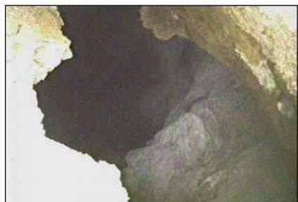
*Imagen 56. .Imágenes que arroja la cámara See Snake al explorar una caverna detectada con barrenación geotécnica; esta exploración con cámara se llevó a cabo ya que se perdieron barras durante la barrenación geotécnica, cumpliendo el objetivo de la barrenación detectando esta caverna.*
