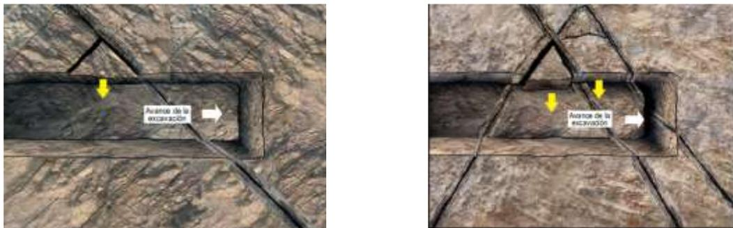
Imagen 59. Riesgos detectados en mina subterránea (Grado de fracturamiento y cuñas formadas por intersección de estructuras) [9]
