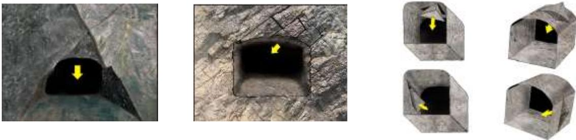
Imagen 58. Riesgos detectados en mina subterránea (cuñas por intersección de estructuras)
