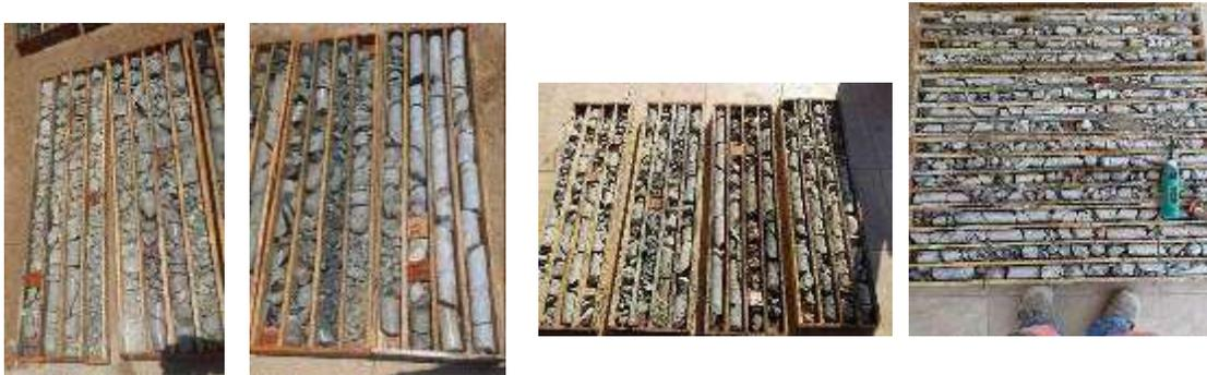
*Imagen 10. Recuperación de barrenos geotécnicos en tobas, apreciándose su calidad muy pobre, su bajo RQD y baja recuperación. Obtenido del informe del Barreno de exploración geotécnica 175, hecho en zona Main Central; barreno realizado para determinar la calidad del macizo rocoso para la planeación a corto plazo.*
