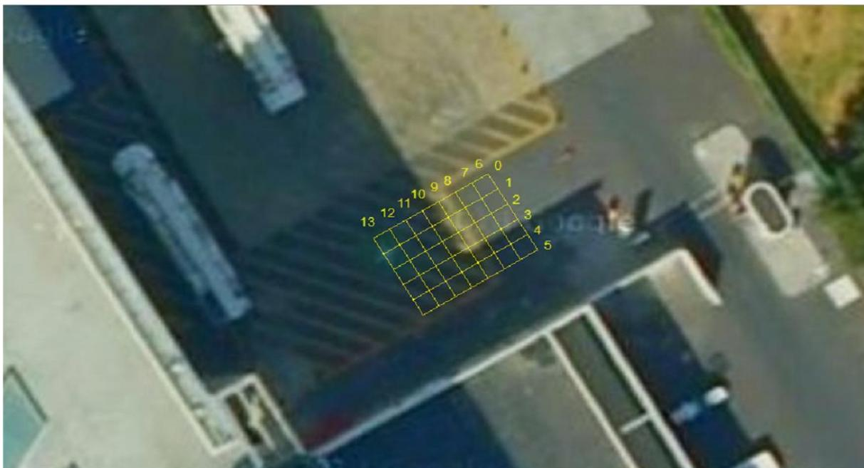
FIGURA 22 ESQUEMA DE LAS LÍNEAS DE GPR IMPLANTADAS EN LA POSICIÓN DEL AEROPUERTO DE LA CIUDAD DE MÉXICO.
